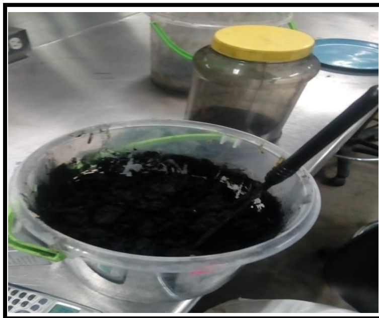
Figura 2.3 mezclado de sólidos insolubles de nopal y carbón activado
