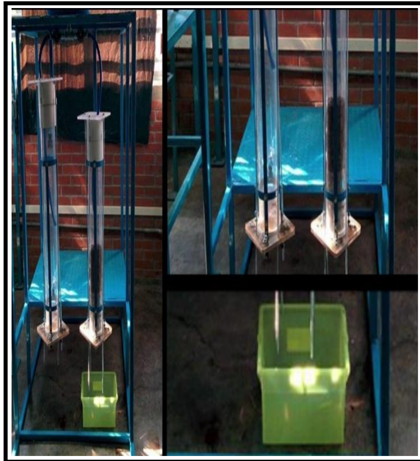
Figura 2.13 Filtro de lechos empacados en operación
