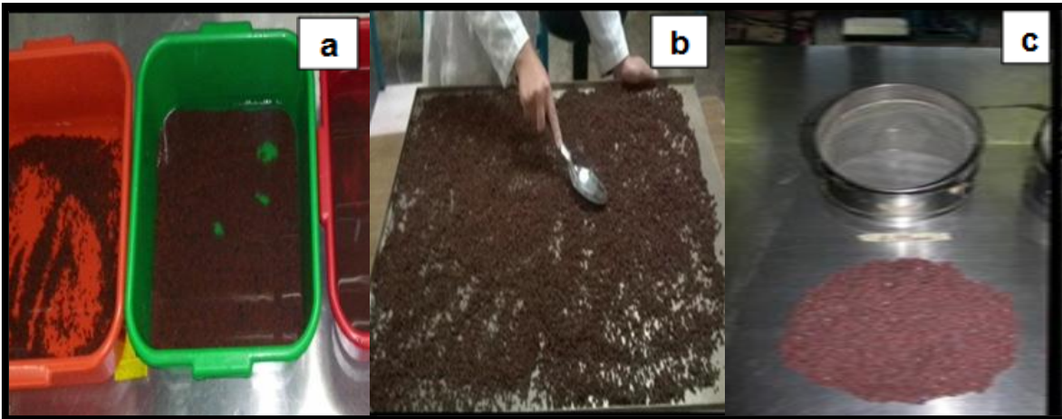
Figura 2.11 selección de tamaño, a) lavado de materiales, b) secado de materiales c) tamizado
