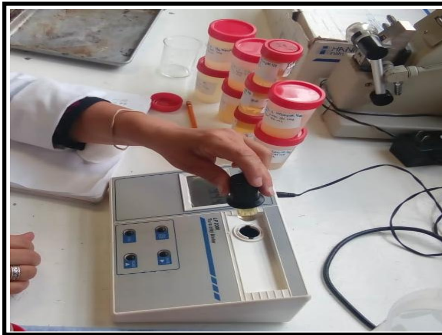
Figura 2.4 Determinación de turbidez de agua residual de nejayote diluido
