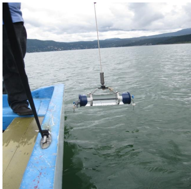
Figura 7. Obtención de muestra de agua mediante botella van Dorn
