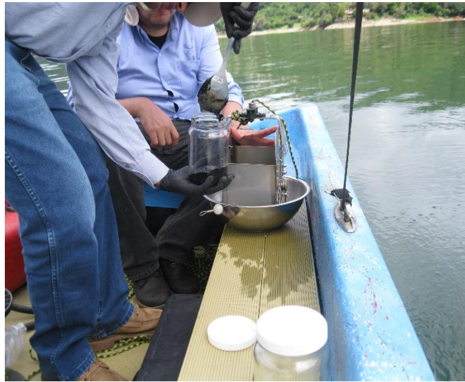
Figura 8. Obtención de muestras de sedimento mediante draga Ekman
