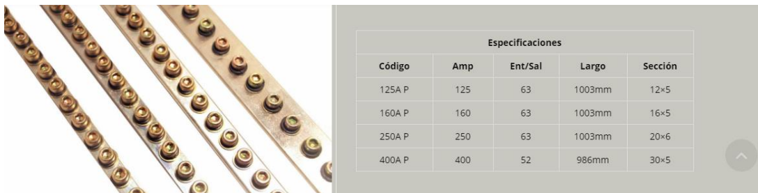
Figura 37 Ejemplo de diversas barras de distribución con sus especificaciones.
