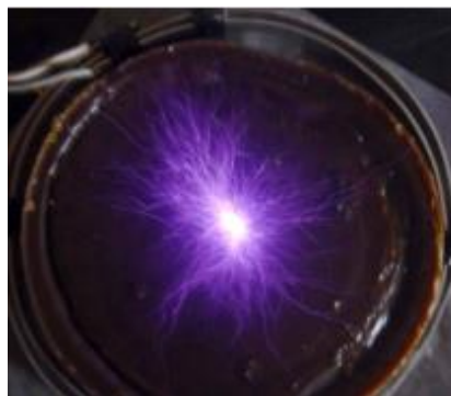
Figura 21 Descarga electrostática de brocha o cepillo. (Vista de frente al objeto con curvatura mayor a 0.5 mm) Se pueden observar los diversos haces que, en conjunto, toman la forma de un cepillo de cabello o una brocha pequeña de mano.
