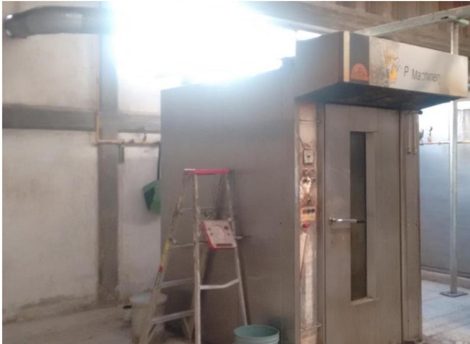
Figura 4. Horno tipo rotativo.
