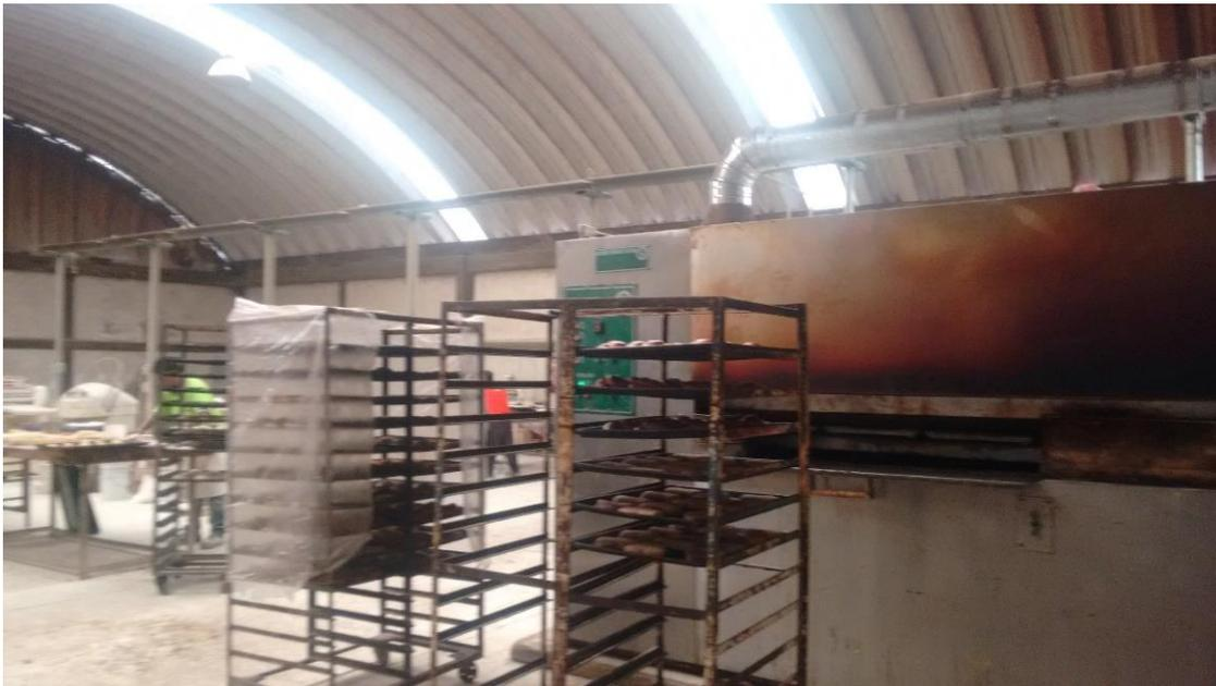
Figura 13. Horno de columpio.
