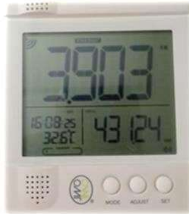
Ilustración 26. Monitor de energía, medición Vitrina de Refrigeración Grande
