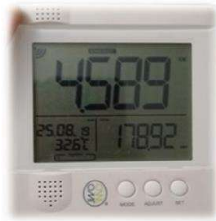
Ilustración 17. Monitor de energía, medición equipo de aire acondicionado número 2
