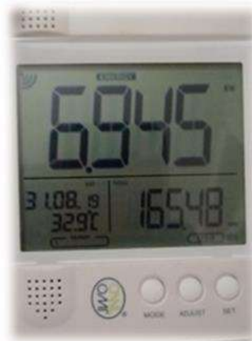
Ilustración 22. Monitor de energía, medición de la máquina lavatrastos
