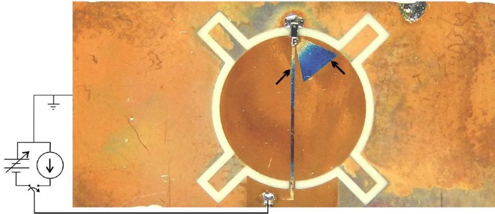
Figura 3.4. Diafragma fabricado y su polarización.
