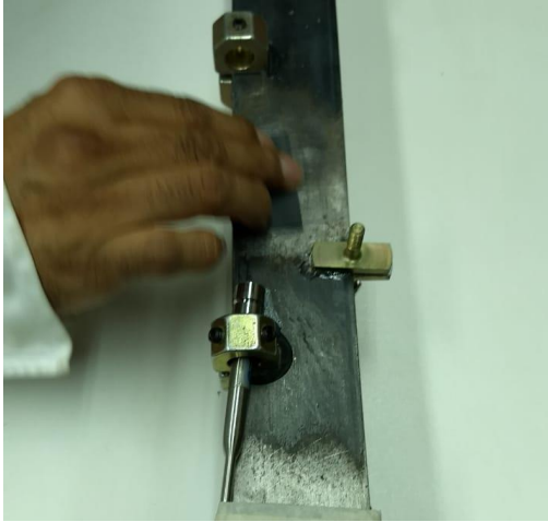
Figura 5.1.3 Lijado de la superficie
