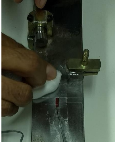
Figura 5.1.14 Limpieza del excedente de pegamento
