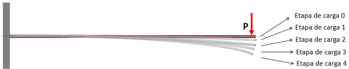
Figura 5.3.46 Esquema de la barra metálica deformada en las diferentes etapas de carga
