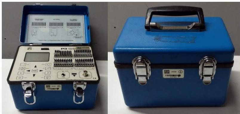
Figura 5.2.1 Puente Vishay modelo P3 (P3)
