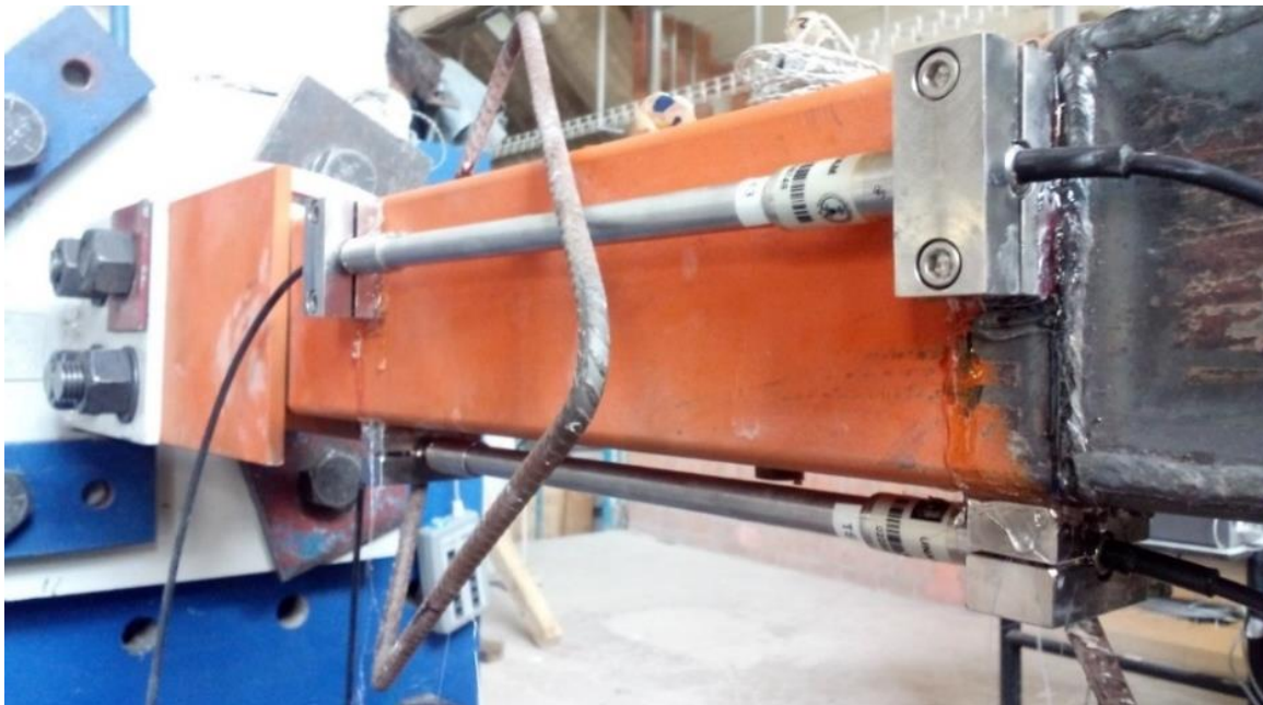
Figura 5.5.10 Colocación de sensores de fibra óptica
