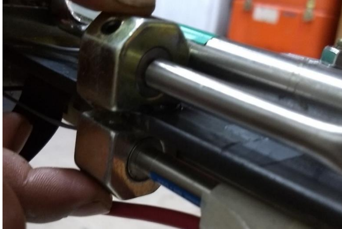
Figura 5.1.31 Fijación de las bases del SCV
