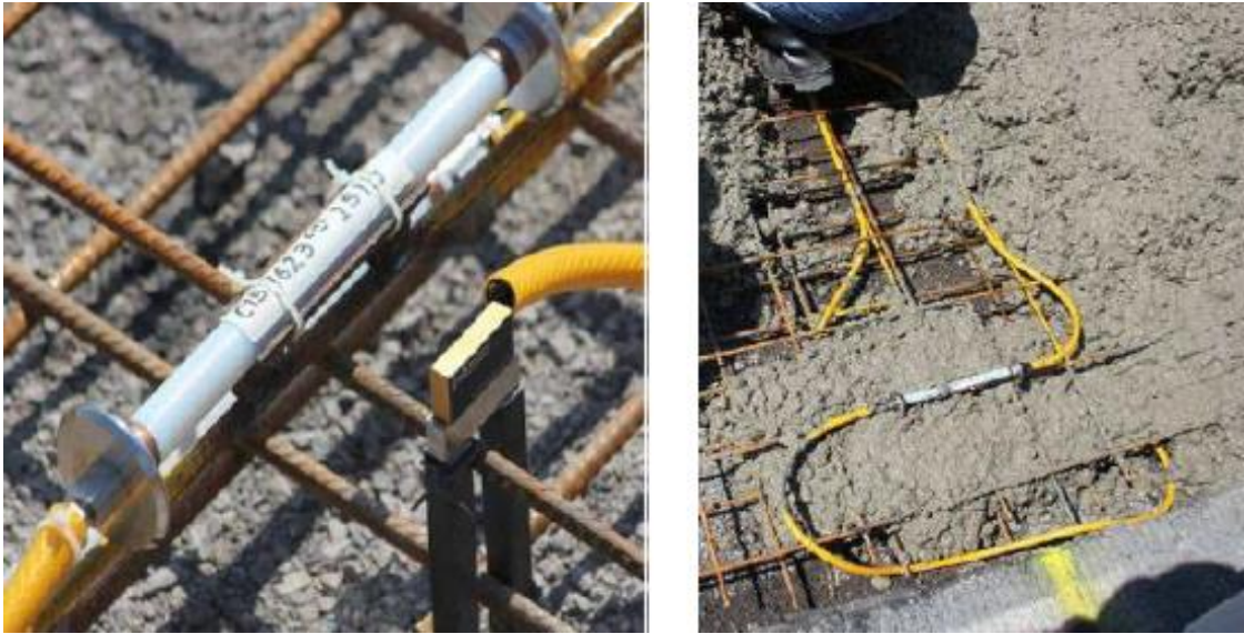
Figura 3.2 SFO embebido en concreto (Notas SHMII-7 Short Course, 2015)
