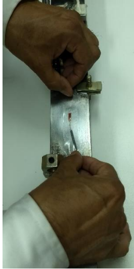
Figura 5.1.8 Colocación del DE sobre la superficie
