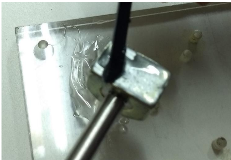
Figura 5.1.30 Aplicación de la mezcla sobre la base de lo SCV
