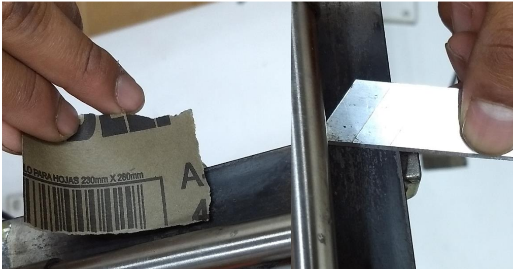
Figura 5.1.25 Remoción de las asperezas sobre la superficie
