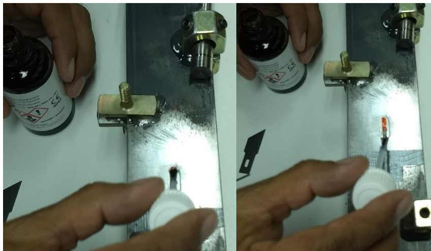
Figura 5.1.19 Aplicación de la resina protectora
