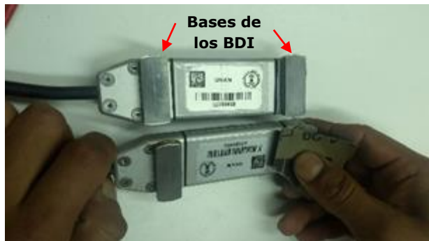
Figura 5.1.21 Limpieza de las bases de los BDI
