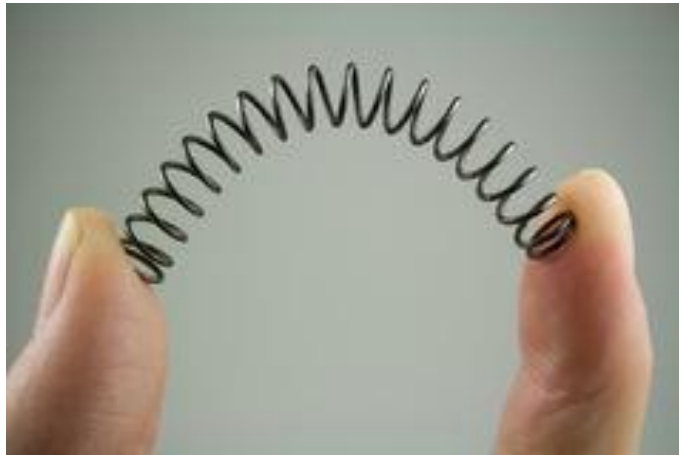
Figura 1.2 Resorte sometido a flexión (Referencia 1.2)
