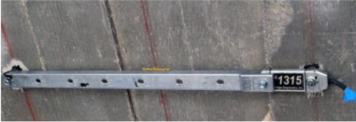
Figura 4.4 Extensión para el sensor BDI (bditest.com)
