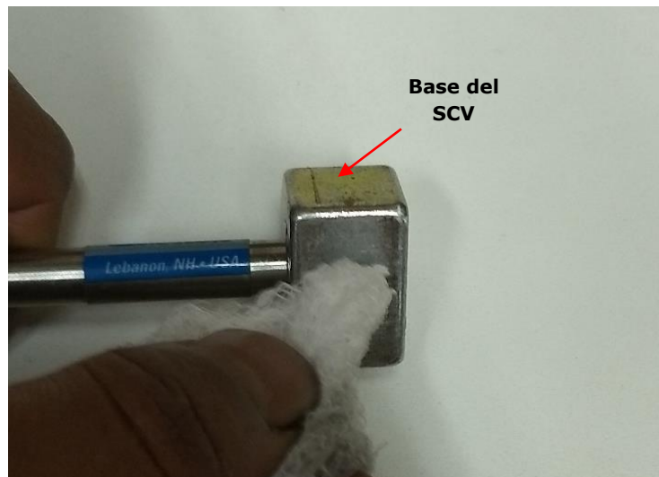
Figura 5.1.28 Limpieza de las bases del SCV
