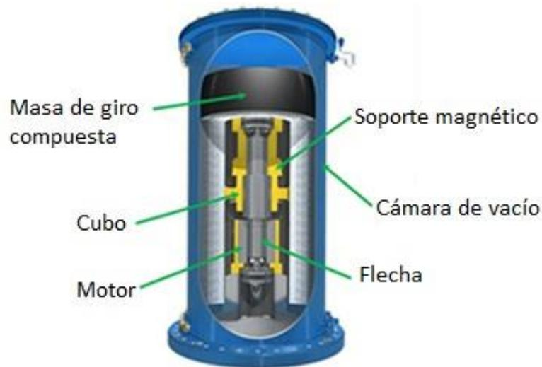
**Figura 4.7** Componentes principales de un volante de inercia.
