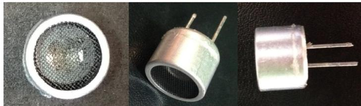
Fig. 2.1.1. Transductores piezoeléctricos utilizados para generar y detectar ondas ultrasónicas. (Fotografías tomadas por autor de este trabajo).
