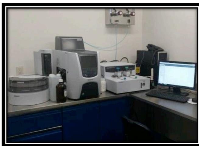
Figura 3. 3 Equipo de determinación de carbono orgánico total TOC-LCSH/CPH
