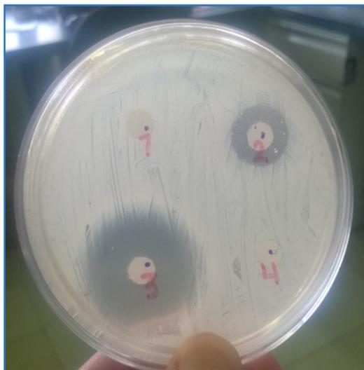
*Figura 4. 18 Zonas de inhibición de crecimiento bacteriano en los ensayos de actividad antibiótica remanente para el material 0.5% Ag/0.5% B-TiO<sub>2</sub>*
