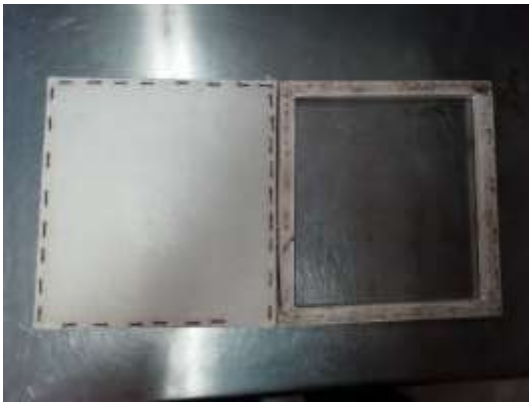
Figura IV-20 Molde para formación de hojas (capturada por el autor)
