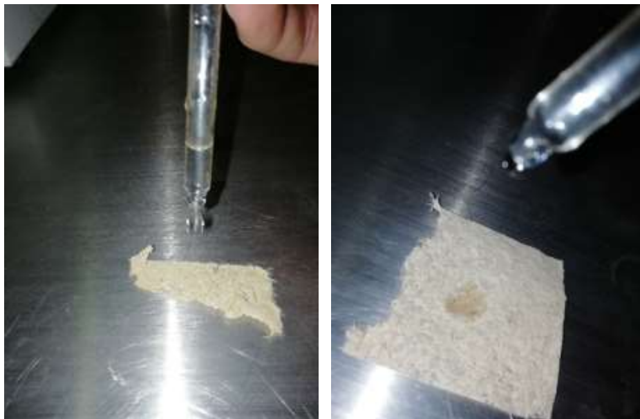
Figura VI-7 Prueba de encolado. Método de la gota (capturada por el autor)
