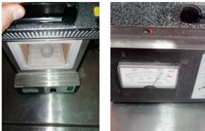
Figura VI-10 Prueba de cenizas. Calentamiento de la mufla (capturada por el autor)
