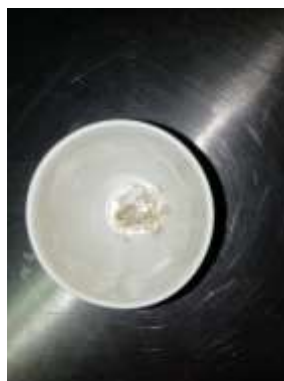
Figura VI-11 Prueba de cenizas. Cenizas obtenidas (capturada por el autor)
