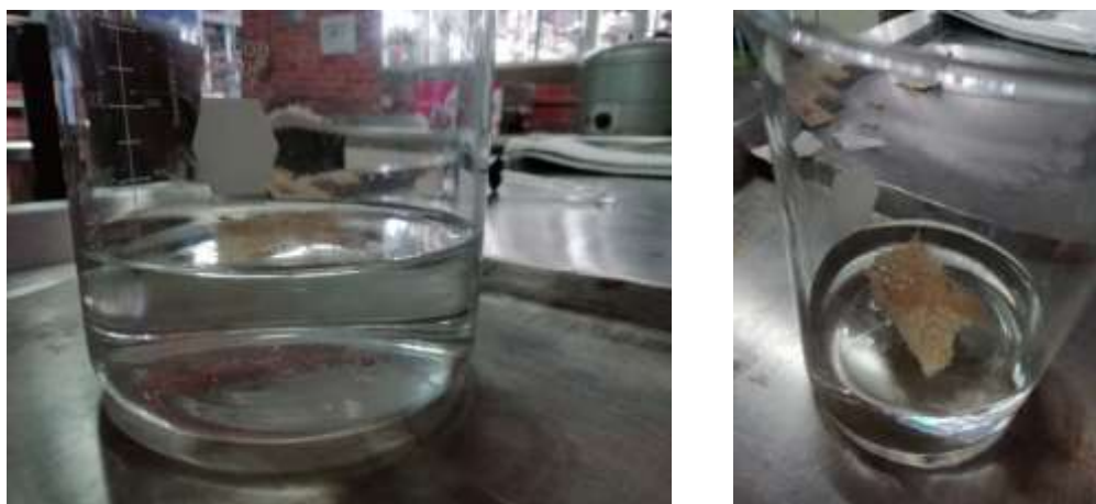
Figura VI-8 Prueba de encolado. Método del vaso (capturada por el autor)
