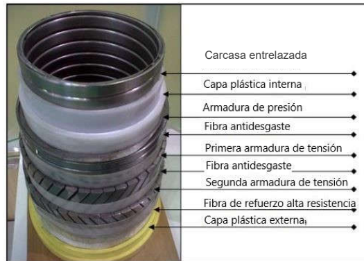
Figura 1.1 Estructura de un riser flexible compuesto por capas poliméricas y metálicas, (Tomado de Vargas (2013), y modificado por el autor)
