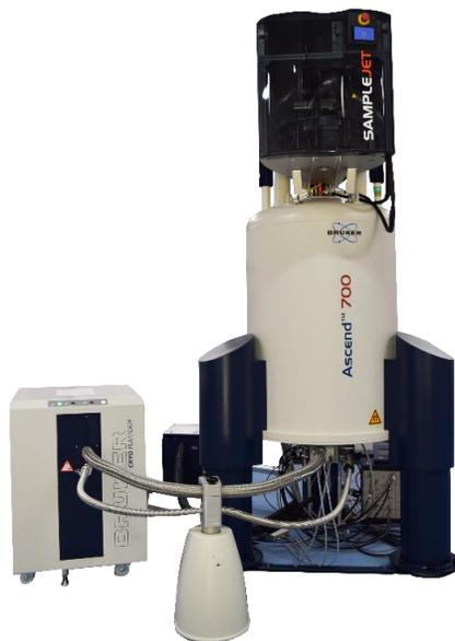
Figura 5. Espectrómetro Bruker Avance III HD 700 MHz (campo magnético de 16.4 T).
