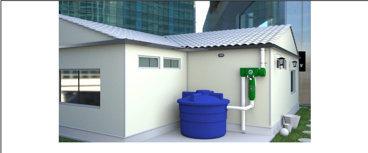
Fig. 13 Cosechas en techos de Vivienda
