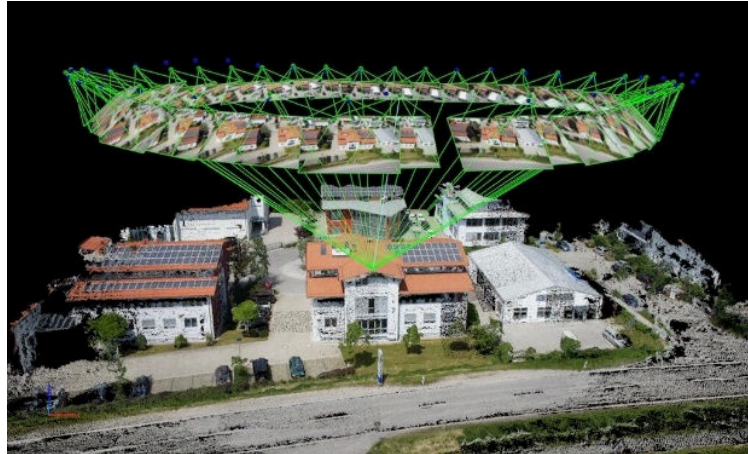
Ilustración 40: Ejemplo De Generación De Un Ortomosaico. Fuente: https://www.lidar-mexico.com/fotogrametria-drones
