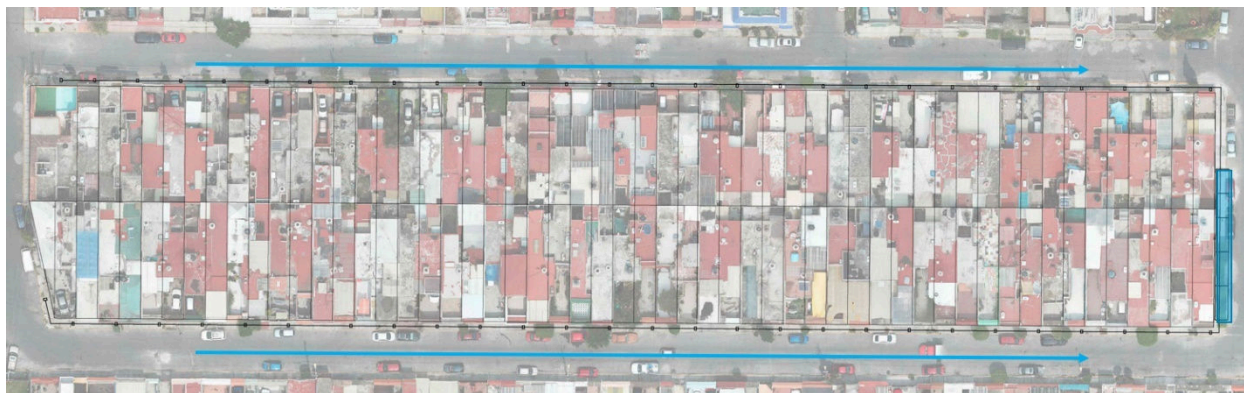
Ilustración 71: Distribución De La Red Perimetral De Agua Pluvial. Fuente: creación propia
