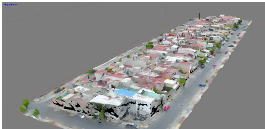
Ilustración 43: Tildado De Nube De Puntos. Fuente: creación propia
