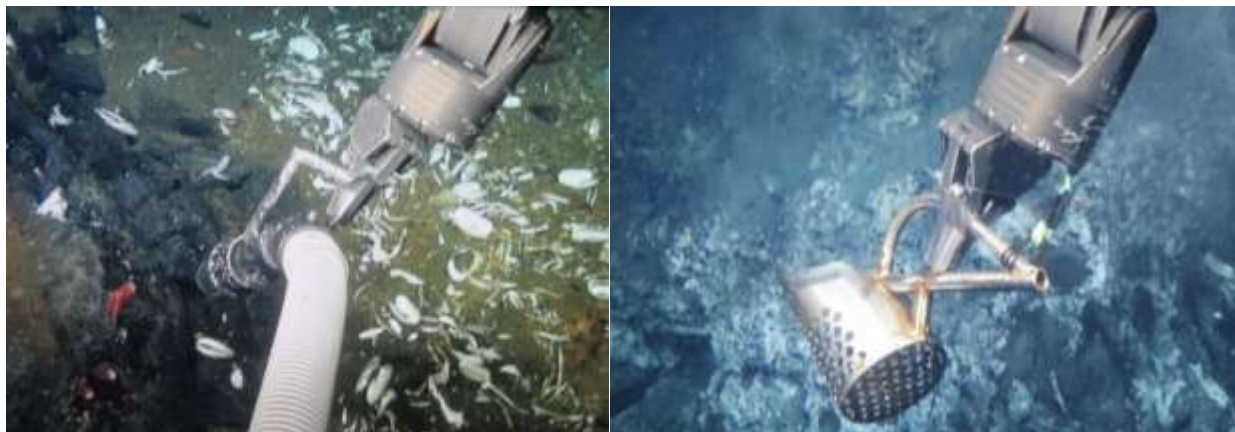
Figura 3. Dispositivos de muestreo acoplados al ROV Doc Ricketts utilizados para la recolección de la fauna asociada a los sistemas hidrotermales aquí analizados.
