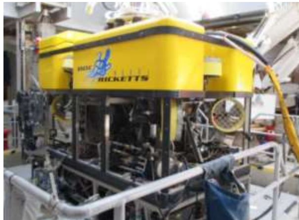
Figura 2. Robot de operación remota Doc Ricketts utilizado para la exploración y toma de muestras de los sistemas hidrotermales aquí analizados.
