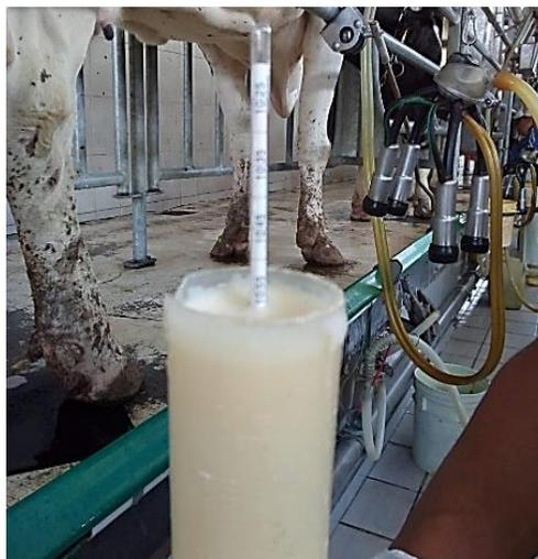
Figura 7. Calostrómetro. Observe donde flota el dispositivo en el calostro, si lo hace en la banda verde significa buena calidad (50-140 g/L de IgG's).
