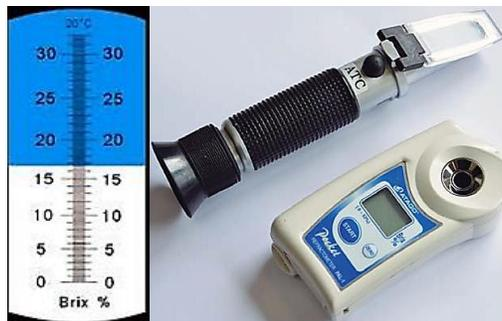
Figura 3. Refractómetro óptico y digital con escala Brix. Su lectura ofrece proporción de sólidos totales en un líquido. Lecturas arriba de 21-23 % significa buena calidad de calostro. (Quigley *et al.*, 2013., Bartier *et al.*,2015).
