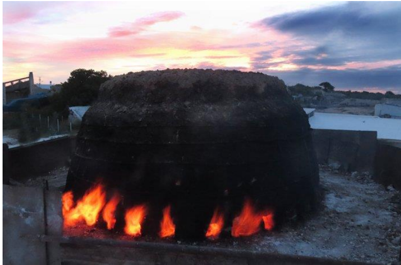
Imagen 122. Horno Calero en Morón de la Frontera, Sevilla. La llama respirando por la parte superior y la piedra al rojo vivo, indicador que se encuentra a 1200°C. Tomado de Manuel Gilortiz, (2011).
