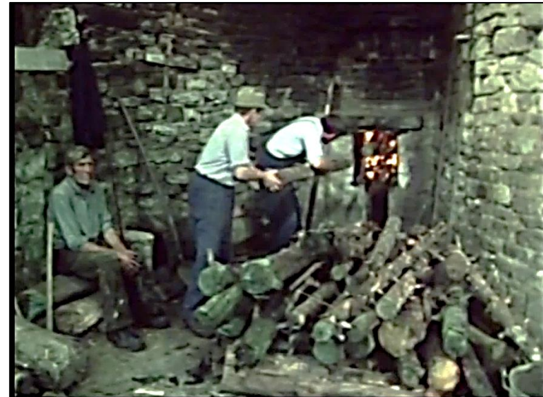
Imagen 120. Alimentación con carbón vegetal, la presencia de la cuadrilla de caleros para controlar el fogón y mantener siempre encendido. Tomado de Gransdorf & Eifel, (1979).
