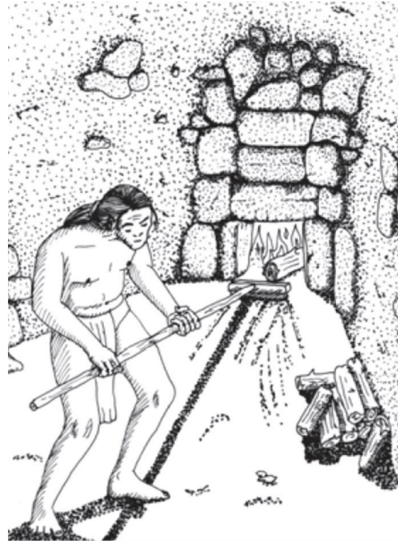
Imagen 125. Alimentación de combustible vegetal por la boca de alimentación. Tomado de Enrique Nalda, (2008).
