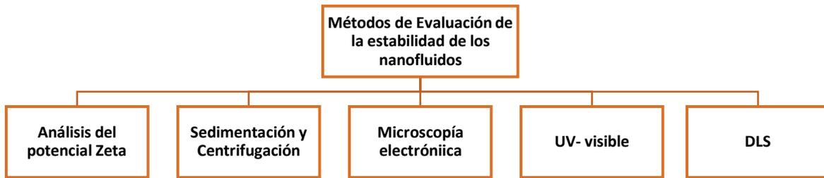
**Figura 2.15.** Métodos para evaluar la estabilidad de los nanofluidos.
