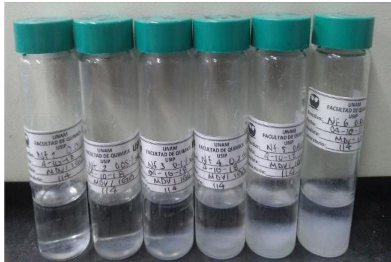
**Figura 4. 15.** Nanofluidos preparados con NPs de SiO<sub>2</sub>.
