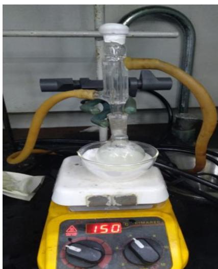
**Figura 4. 11.** Desagregación de las NPs de SiO<sub>2</sub> mediante un sistema a reflujo.
