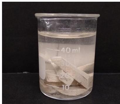
**Figura 4. 21.** Añejamiento de las láminas de roca MIG-R en carboxilatos.
