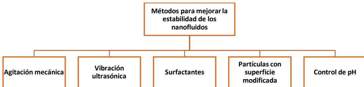
**Figura 2.14.** Métodos para mejorar la estabilidad de los nanofluidos.
