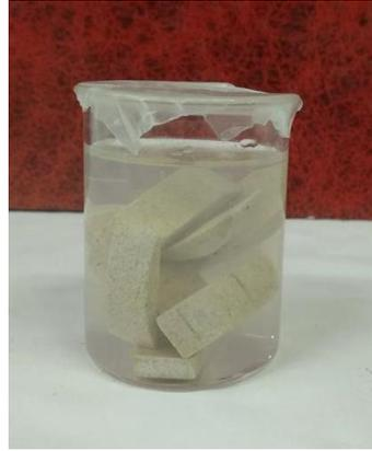
**Figura 4. 20.** Añejamiento de láminas de roca MIG-R en salmuera estabilizada MIG-S.
