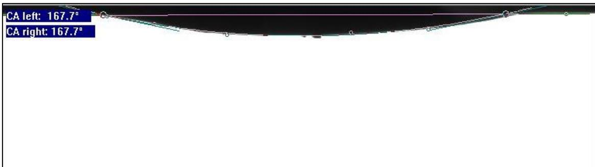
**Figura A3. 16.** Ángulo de contacto de aceite MIG-A en agua de la CAB MIG-S y roca M296 añejada en nanofluido ZnO/SiO<sub>2</sub>.
