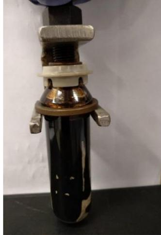
**Figura 4. 22.** Añejamiento de láminas de roca MIG-R en aceite MIG-A.
