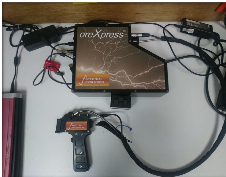
Figura III.6. Equipo utilizado para espectroscopía de infrarrojo cercano (SWIR).
