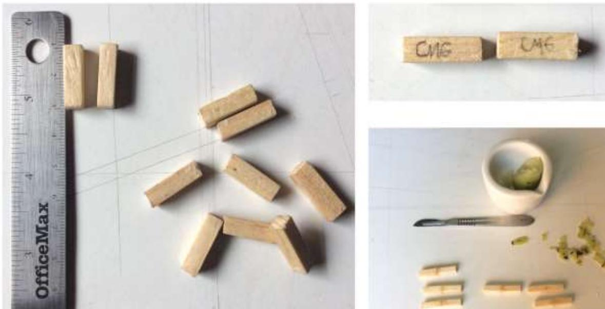
Figura 46: Preparación de probetas de madera de pino adheridas con *Cyrtopodium macrobulbon*.
