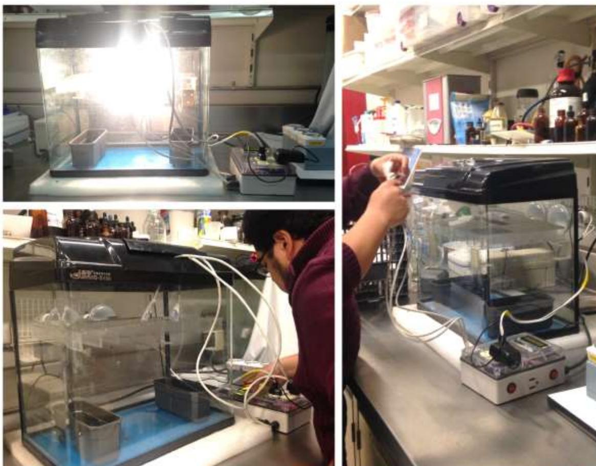
Figura 47: El Mtro. Armando Arciniega Corona colocando las probetas dentro de la cámara de envejecimiento del Laboratorio de Conservación, Diagnóstico y Caracterización Espectroscópica de la Coordinación Nacional de Conservación del Patrimonio del INAH, septiembre de 2017.
