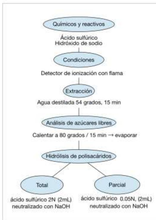
Figura 56: Secuencia a seguir para las pruebas de cromatografía de Gases Capilar a alta temperatura. (HT\_CGC)
