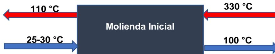
Diagrama 4.1 Temperaturas de entrada y salida de gases de combustión y materia prima en la molienda inicial.
