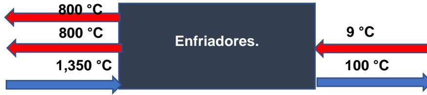
Diagrama 4.5 Temperaturas de entrada y salida de gases de combustión y materia prima en los enfriadores.
