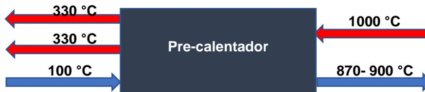
Diagrama 4.2 Temperaturas de entrada y salida de gases de combustión y materia prima en el pre-calentador.
