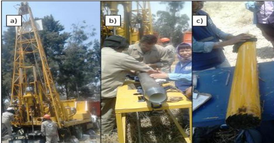
Figura 10.- Metodología utilizada para la extracción del núcleo XOC17-I: a) máquina perforadora Mobile Drill B-61; b) muestreador TGC con un tubo interior de PVC; c) nucleador tipo Shelby (tubos de acero dentado).
