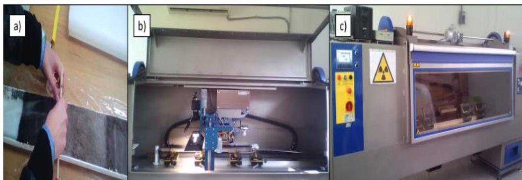
Figura 12.- Etapas realizadas en el análisis de FRX. A) preparación de los sedimentos para ser analizados. B) toma de fotografías de alta resolución de los sedimentos. C) medición de los elementos mayores y traza con el equipo Avaatech XRF Core Scanner.
