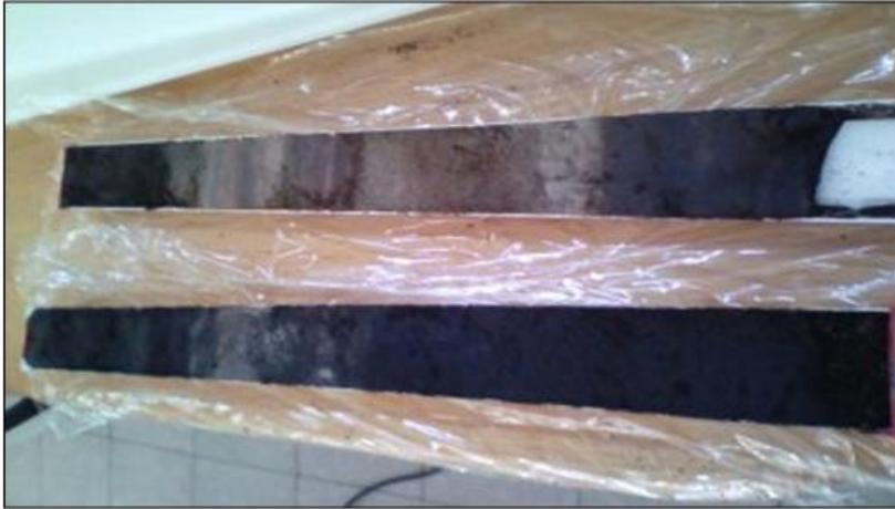
Fig.11.- Se muestra un ejemplo de cómo se disectan los tramos de sedimento del núcleo XOC17-I, para llevar a cabo las descripciones pertinentes.
