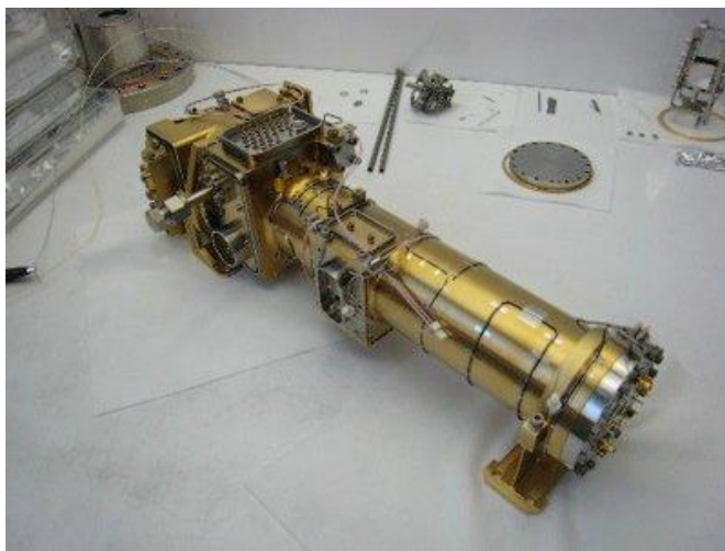
Figura 27. (Tomada de NASA/JPL/Emily Lakdawalla) Espectrómetro de masas cuadrupolar del instrumento SAM. Del lado izquierdo en el extremo más lejano se encuentra la fuente de ionización del espectrómetro. En la sección tubular alargada se encuentra el sistema cuadrupolar del QMS. Del lado derecho en el extremo más cercano se encuentra el detector del espectrómetro.
