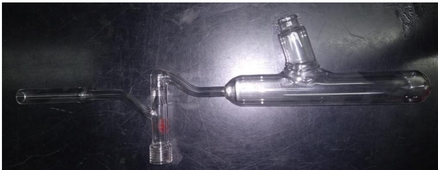
Figura 45. Se muestra el reactor de vidrio empleado para realizar los experimentos simulados de LR. Se puede apreciar que el cuerpo está formado principalmente por un cilindro de vidrio adaptado con la boquilla de un vial en uno de sus costados. En la parte superior se muestra la adaptación para poder someter el dispositivo a la entrada o evacuación de gases.
