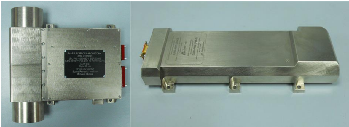
Figura 14. (Combinado de Mitrofanov et al., 2012). Componentes del instrumento DAN del “rover” Curiosity. Del lado izquierdo se muestra el detector con su módulo electrónico. Del lado derecho se muestra el generador de pulsos de neutrones.
