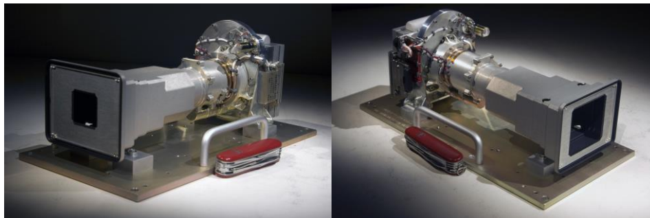
Figura 9. (Tomadas de Grotzinger et al., 2012) Del lado izquierdo se muestra la cámara M-100, del lado derecho se muestra la cámara M-34. Se puede apreciar que ambas se encuentran con una navaja como comparativa de tamaño. Se puede apreciar que prácticamente la única diferencia entre ellas es la apertura de su lente.
