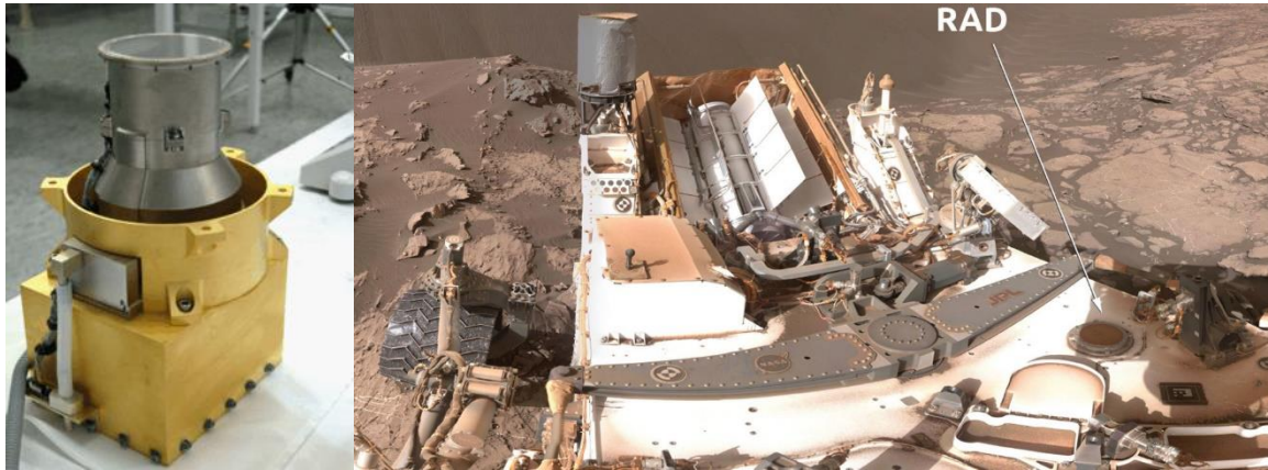
Figura 16. (Combinado de Grotzinger y NASA/JPL/Caltech) Instrumento RAD y su ubicación en el “rover” Curiosity. Del lado izquierdo se muestra el Instrumento RAD. Se puede apreciar que en la parte superior se encuentra el telescopio del equipo. Debajo de éste, se encuentra la unidad electrónica del equipo. Del lado derecho se muestra el lugar del instrumento dentro del “rover”. En ambas imágenes se puede apreciar que el instrumento se encuentra apuntando hacia arriba.
