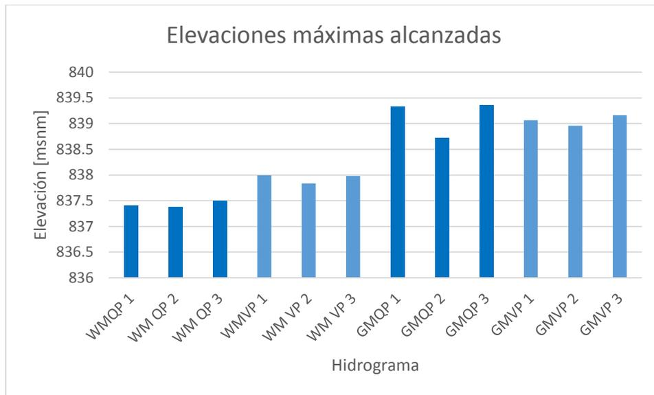
Figura 6.32 Elevaciones máximas alcanzadas en el vaso de la presa La Angostura, 10 días
