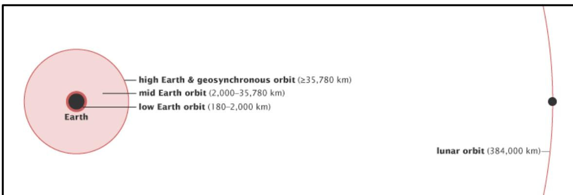
Figura 4 - Representación gráfica de los distintos tipos de órbitas circulares: órbita alta (HEO & GEO), órbita media (MEO) y órbita baja (LEO) [9].
