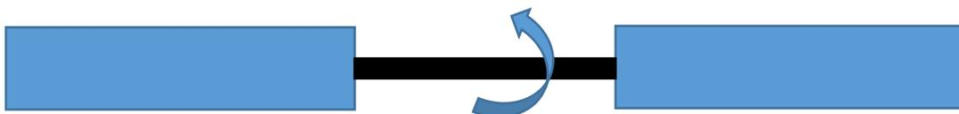
Figura 40 - Esquema simplificado del mecanismo de rotación, se muestran el eje del motor en negro (eje de rotación) y el arreglo de paneles solares en azul [Vista superior].
