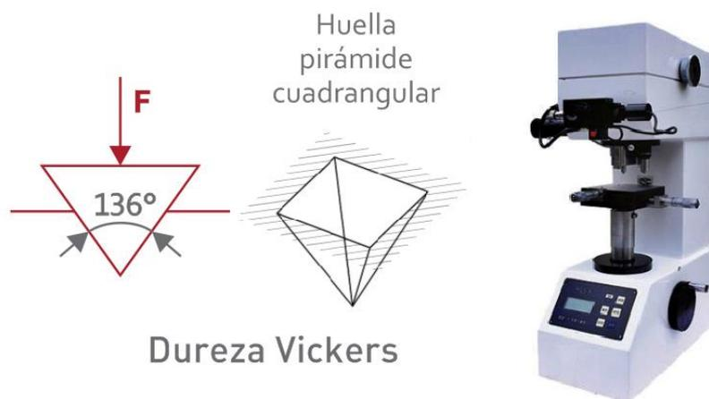
Figura 2.13 Ensayo de dureza Vickers
