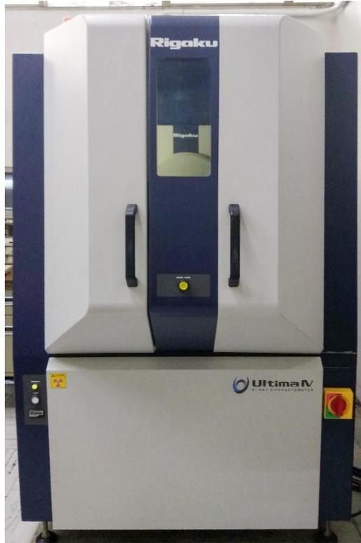
Figura 3.4.2: Fotografía del equipo Rigaku Ultima IV.
