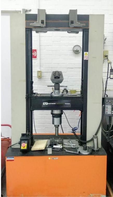
Figura 3.2.4: Máquina universal de pruebas INSTRON modelo 1125, usada en el proceso de deformación plástica severa.
