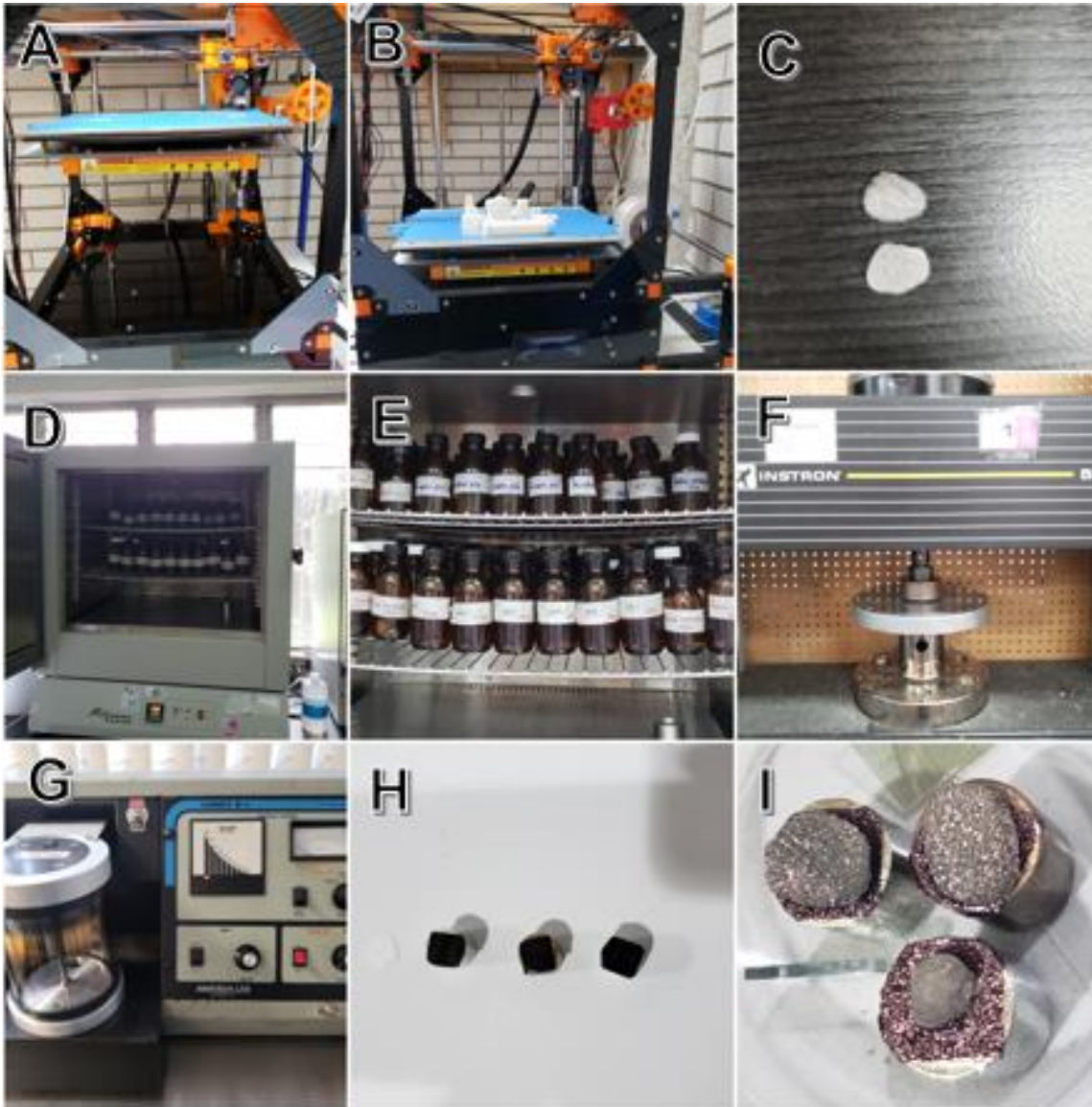
Figura 5. Fase in vitro . (A)- (B) Impresión de andamios 3D (C) Andamios de PLA (D) - (E) Frascos ámbar previamente marcados, colocados en estufa Felissa (F) Máquina Instron, prueba de compresión (G) Andamios de PLA procesados para crear vacío y bañarlos en nano partículas de oro (H) - (I) Andamios de PLA recubiertos con nano partículas de oro—Fuente directa.
