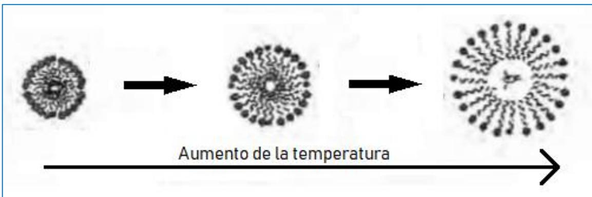
Figura 13. Efecto de la temperatura sobre el tamaño del núcleo de la micela [51].
