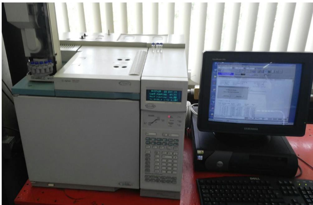
Figura 20. Cromatógrafo de gases utilizado para el seguimiento de las reacciones
