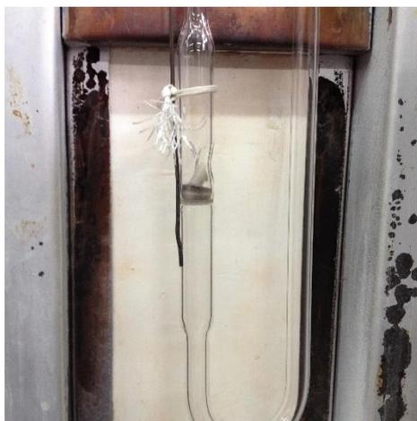
Figura 17. Reducción del catalizador en reactor tipo U.
