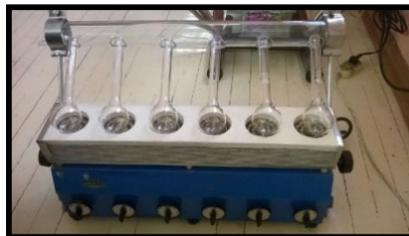
**Figura 31.** Digestor utilizado en el método de Microkjeldahl
