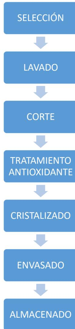
**Figura 10.** Diagrama de proceso para elaboración de fruta cristalizada.
