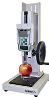
**Figura 22.** Penetrómetro utilizado en la determinación de firmeza.
