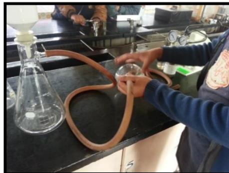
**Figura 33.** Filtración de muestras en la determinación de fibra
