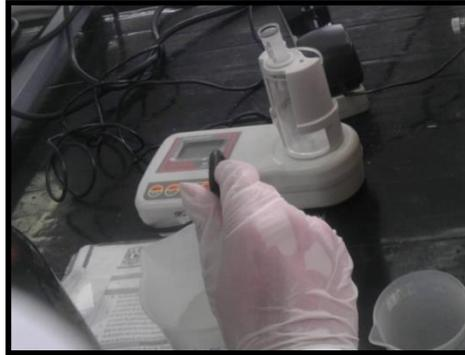
Figura 25. Determinación de pH a una muestra de carambola.
