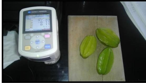
**Figura 23.** Colorímetro Minolta utilizado en la determinación de color.
