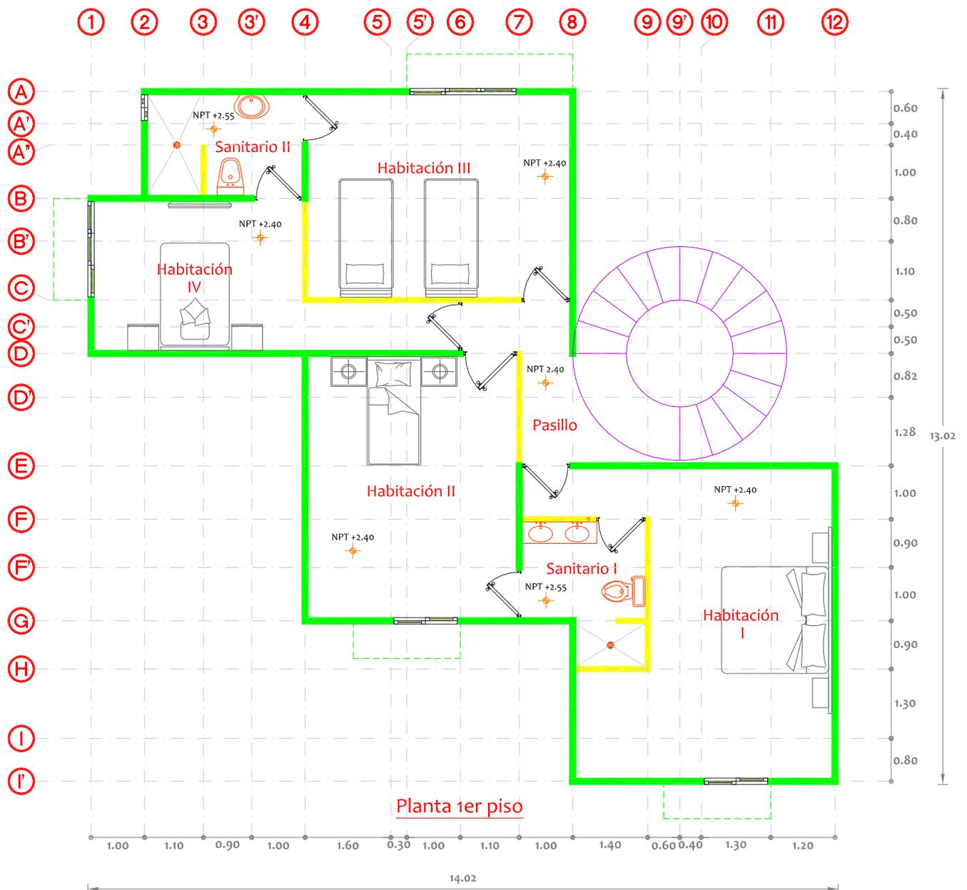
Los muros señalados en amarillos son divisorios por lo tanto no rigen las normas de diseño estructural. No habrá ventanas detrás de la cabecera de la cama. Las ventanas de las habitaciones tendrán balcones de 70 centímetros de ancho. Ningún local podrá ventilar hacia las escaleras, pasillos o andadores. Las ventanas de los baños no podrán ser ubicadas arriba del lavabo ni directamente frente a la regadera.
