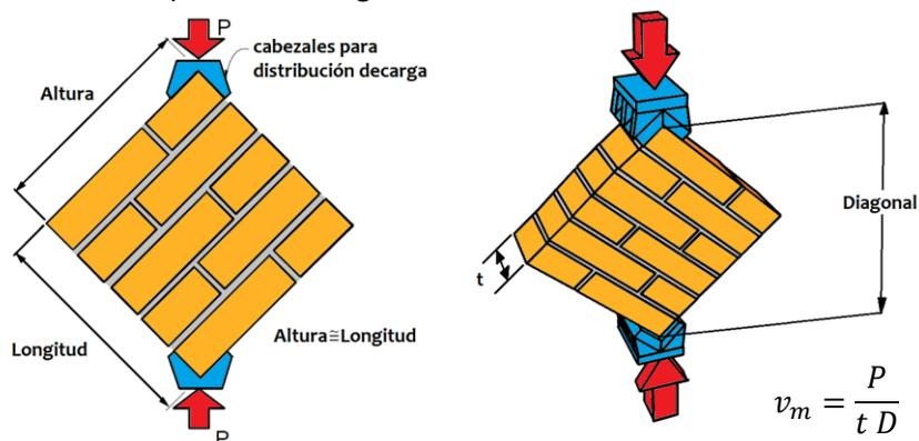
La falla de un muro por efecto de fuerzas cortante ocurre generalmente a través de grietas inclinadas debidas a tensiones diagonales. Estas grietas se forman generalmente a lo largo de las juntas, propiciadas por la debilidad de la unión pieza-mortero, sin embargo, para piezas con baja resistencia y buena adherencia en el mortero, las grietas atraviesan indistintamente piezas y mortero.
