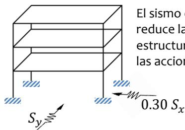
El sismo en ambas direcciones será el correspondiente al espectro de diseño inelástico, el cual reduce las fuerzas de inercia de acuerdo a las características de la estructura, ya que si la estructura se diseña con las fuerzas reales sería incosteable construir un elemento que resista las acciones.
