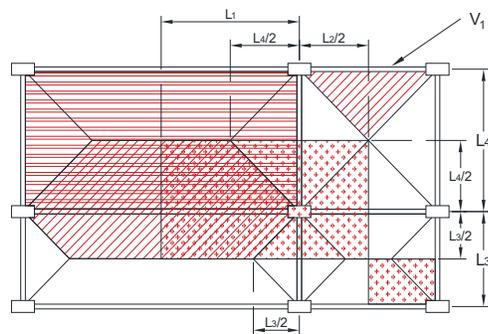
Sistema de piso con losa en dos direcciones con vigas principales y columnas
