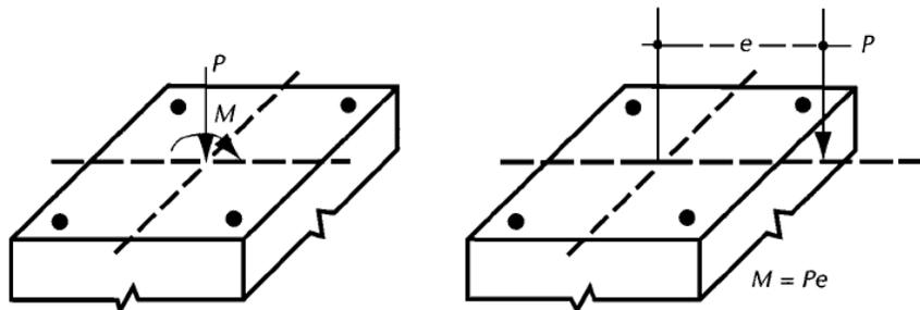
Elementos equivalente sujetos a flexocompresión
