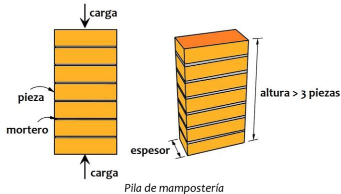
El espesor de las hiladas y acabado de juntas deben determinarse en función de la variabilidad de la altura de pieza de mampostería y del espesor mínimo recomendable del mortero para lograr una correcta adherencia. Para condiciones normales de asentado, el espesor de la junta estará entre 10 y 15 mm. No son aceptables juntas de mortero excesivas porque reducen la resistencia a la compresión de la mampostería; tampoco lo son aquellas que sean delgadas porque reducen su resistencia tensión.
