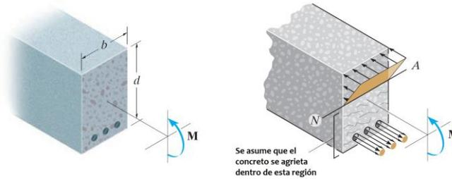
Esfuerzos elásticos en una viga de concreto reforzado debido a momento flexionante
