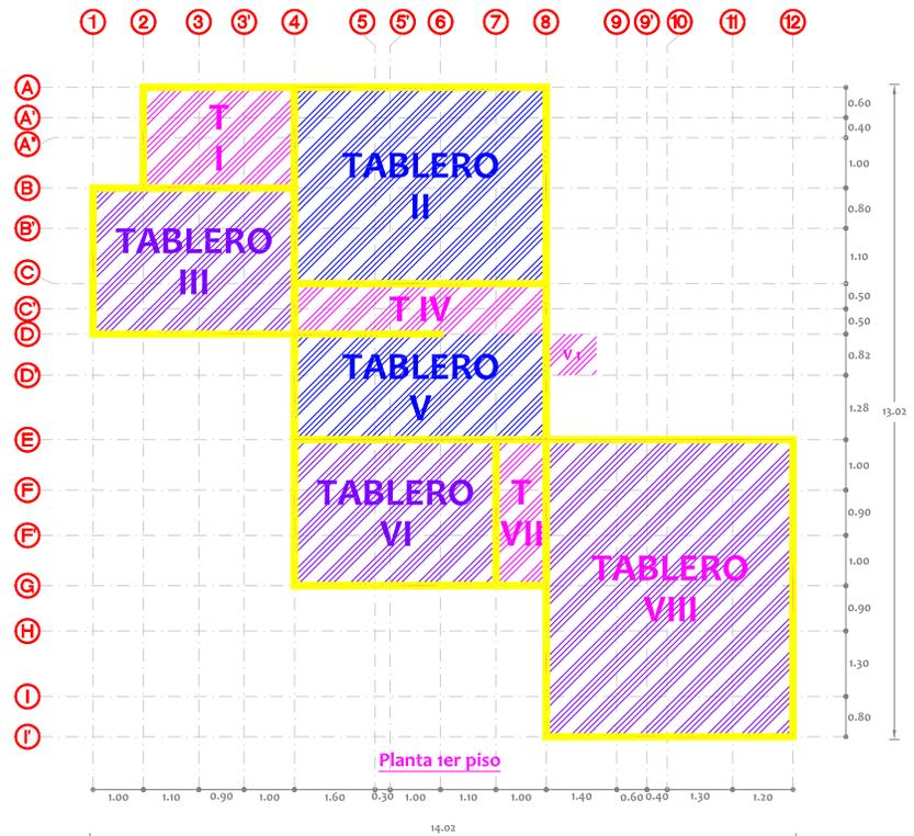
La losa del cuarto de servicio ayudará a resistir las cargas referentes al peso del tinaco.
