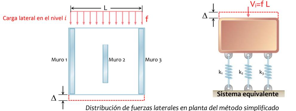
El método simplificado se basa en la distribución de fuerzas laterales de estructuras simétricas con diafragmas rígidos cuando la carga lateral se aplica en una sola dirección. También permite el empleo de diafragmas horizontales que no sean losas de concreto reforzado, siempre que tengan suficiente resistencia y rigidez.
