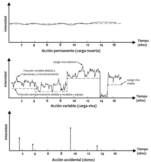
Los tres tipos de carga son variables aleatorias, ya que se tienen incertidumbres de distinto tipo al determinar el efecto de dichas acciones sobre las estructuras. Aunque puede considerarse que una acción permanente tiene una intensidad constante con el tiempo, esto no significa que dicha intensidad pueda predecirse con exactitud.
