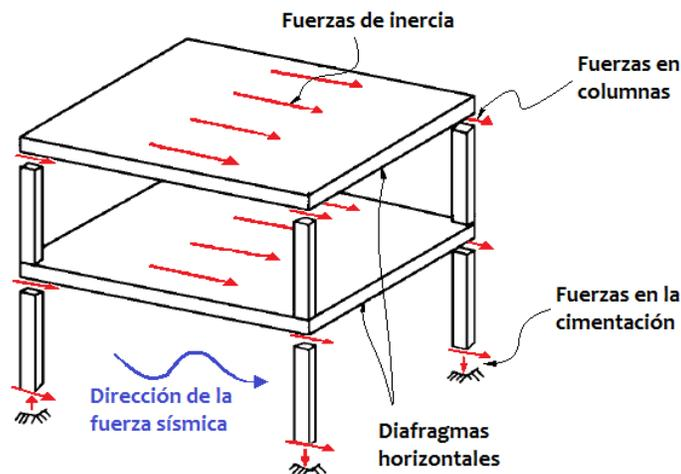
La determinación de las fuerzas internas en los muros se hará en general por medio de un análisis elástico. En la determinación de las propiedades elásticas de los muros deberá considerarse que la mampostería no resiste tensiones en dirección normal a las juntas y emplear por lo tanto las propiedades de las secciones agrietadas transformadas cuando dichas tensiones aparezcan.
