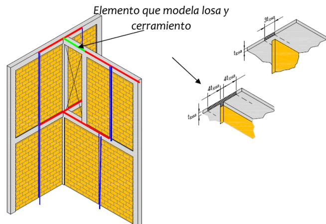
los bloques sobre los que se apoya la losa no aportan rigidez suficiente por lo que se utiliza una sección transversal de peralte igual al del dintel y el módulo de elasticidad del concreto normal.
