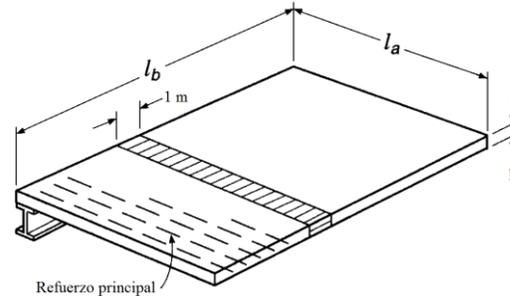
El diseño de estas losas es, por consiguiente, similar al de las vigas. Se recomienda iniciar el diseño fijando un valor de peralte que garantice que no ocurran deflexiones excesivas, ya que esto es el factor que suele regir en el diseño.
