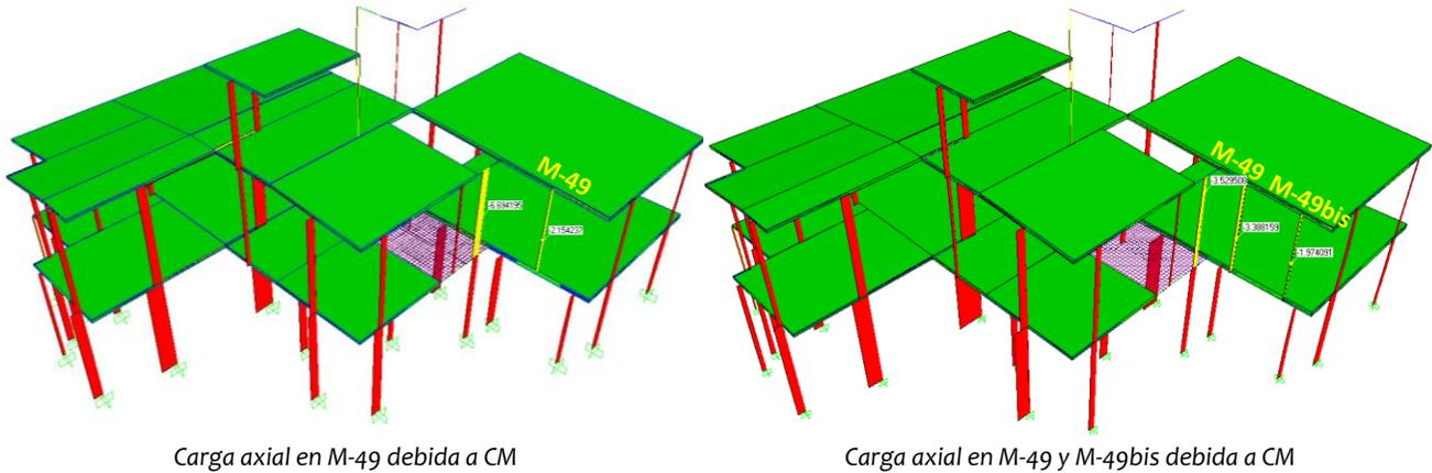
6. Para simular los diafragmas rígidos de la estructura se utilizaron elementos Shell – Thin o cascarón delgado con el mismo espesor de cada losa. No se utilizó la herramienta de diafragma rígido por la complejidad de colocar losas inclinadas, la cual consiste en agrupar los puntos referentes al nivel de la losa e indicarle hacia donde se moverán asignando un Nodo Maestro, esto sólo es válido para puntos que están en una misma cota.
