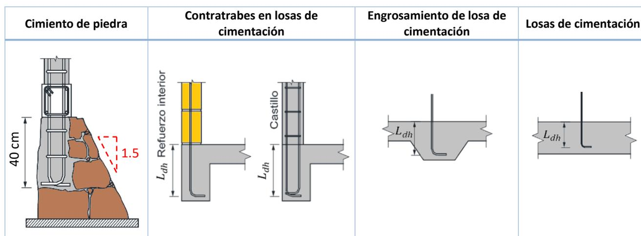
Es muy importante que el anclaje de los castillos sea adecuado, ya que usualmente se corrigen las deficiencias de posición con dobleces del acero.
