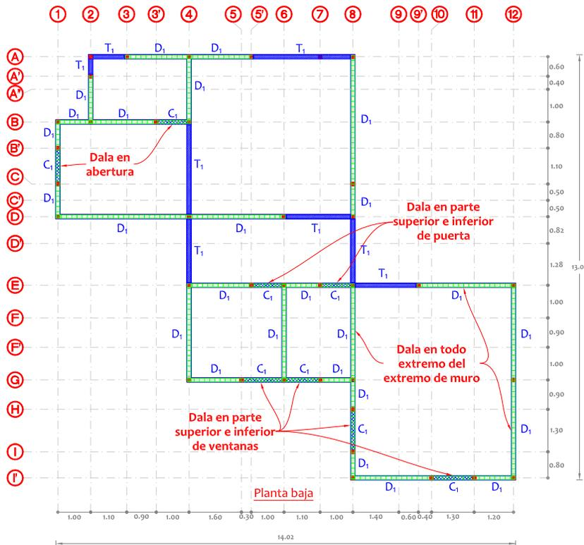
Las vigas se colocan sobre claros largos. Por ejemplo, en el caso de una abertura donde los claros sean muy cortos, no se pondrá una viga sino un cerramiento que ayude a transmitir la carga a los muros inmediatos. También, si la losa es capaz de transmitir el peso a los muros sin deflexionarse, no será necesario un elemento viga. Lo anterior, dependerá en rigor al análisis estructural que arroje los resultados de las fuerzas con las que se diseñará el elemento.
