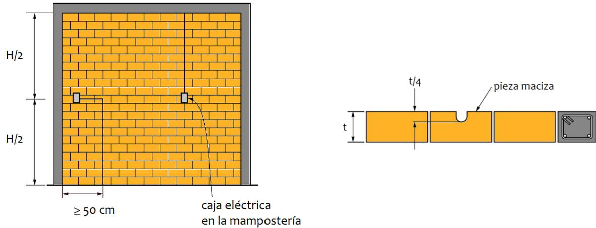
Se deberá verificar que las instalaciones hidráulicas, sanitaria y eléctricas no interfieran con las dalas y castillos.
