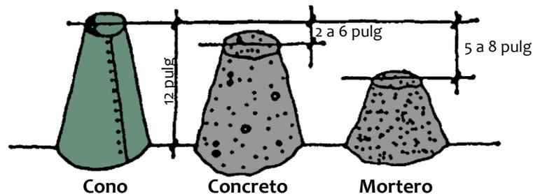
Son necesarios diferentes valores de revenimientos para los varios tipos de construcción. Generalmente, se indica el revenimiento en la especificación de la obra como un rango o como un valor máximo que no puede exceder. Cuando no se especifica el revenimiento, un valor aproximado se elige de la siguiente tabla.
