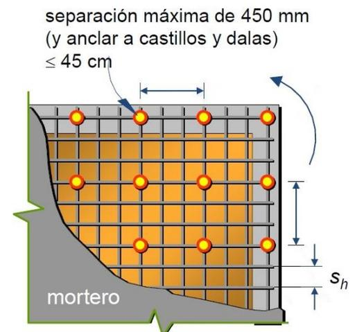
Si el diámetro de los alambres de la malla no permite doblarla alrededor de bordes verticales de muros y aberturas, se aceptará colocar un refuerzo en forma de letra "C" hecho con malla de calibre no inferior al 10 (3.43 mm de diámetro) que se traslape con la malla principal.
