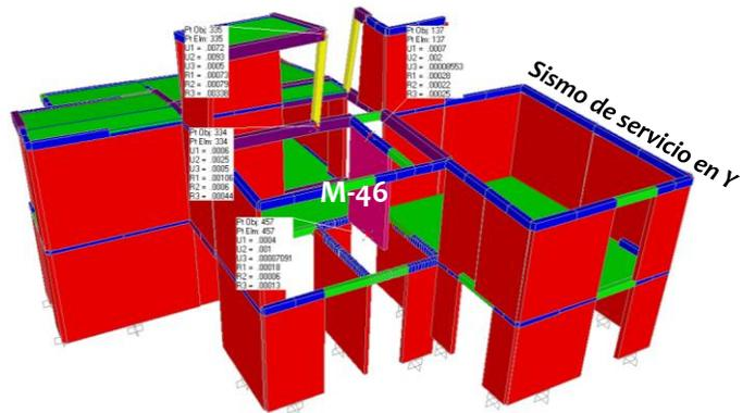
Las distorsiones de la estructura son correctas debido a que los desplazamientos reales son inferiores a los límites permisibles.
