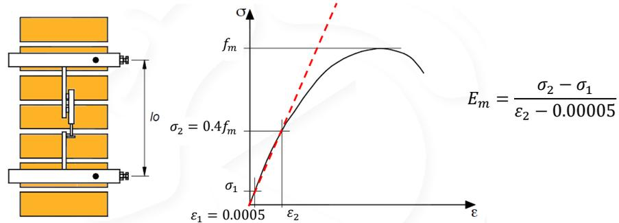
Para obtener el módulo de elasticidad para cargas sostenidas, optativamente, el módulo de elasticidad para cargas de corta duración obtenida del ensaye de pilas se podrá dividir entre 2.3 si se trata de piezas de concreto o entre 1.7 si se trata de piezas de barro o de otro material diferente del concreto.
