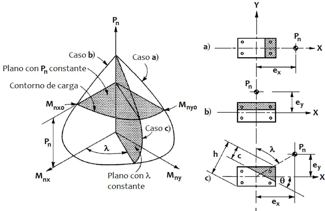
Son aplicables las hipótesis para la obtención de resistencia a flexocompresión.
