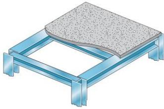
Las losas apoyadas perimetralmente son aquellas que están apoyadas sobre vigas o muros en sus cuatro lados y que por lo tanto trabajan en dos direcciones.
