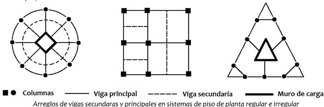
Cuando el peralte de las vigas no es netamente superior al de las losas, ya no es aceptable suponer que estas constituyen apoyos infinitamente rígidos para las losas y es necesario considerar el conjunto viga-losa el que tiene que transmitir las cargas por flexión en dos direcciones.
