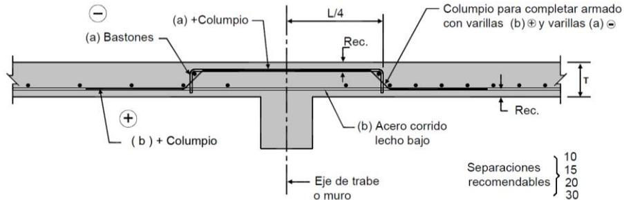
Detalle típico para armado de losa
