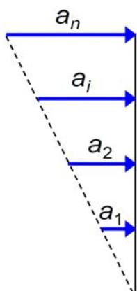
1. Se supone una variación lineal de las aceleraciones con la altura sobre el nivel en que se acepta que los desplazamientos de la estructura con respecto al terreno son nulos.
