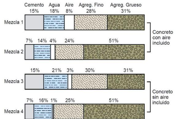
Como los agregados constituyen aproximadamente del 60% al 75% del volumen total del concreto, su selección es muy importante. Los agregados deben componerse de partículas con resistencia mecánica adecuada y con resistencia a las condiciones de exposición y no deben contener materiales que puedan causar deterioración del concreto.
