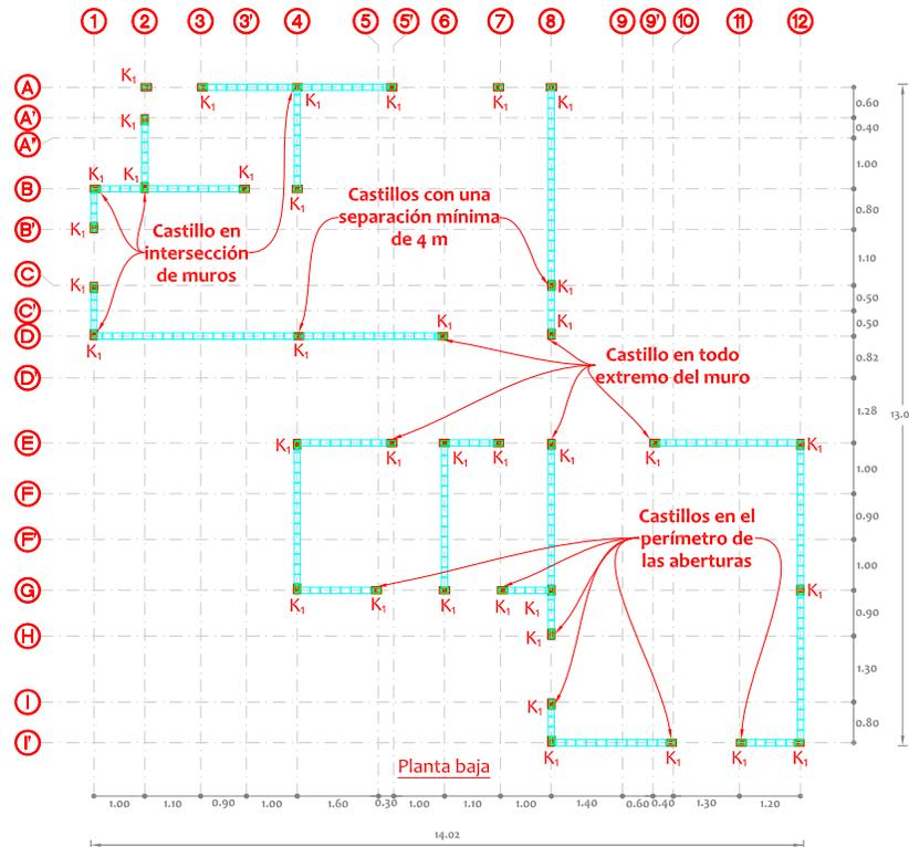
La presencia de castillos en las aberturas como ventanas y puertas o accesos principales es de gran importancia pues se ha logrado observar la aparición de grietas cuando la abertura no se confina bien. Las fisuras ocurren debido a una carga accidental o al peso propio de la estructura. Como todas las aberturas tienen algún lado mayor a 60 cm para estructuras de mampostería del tipo I existirán castillos como refuerzo.
