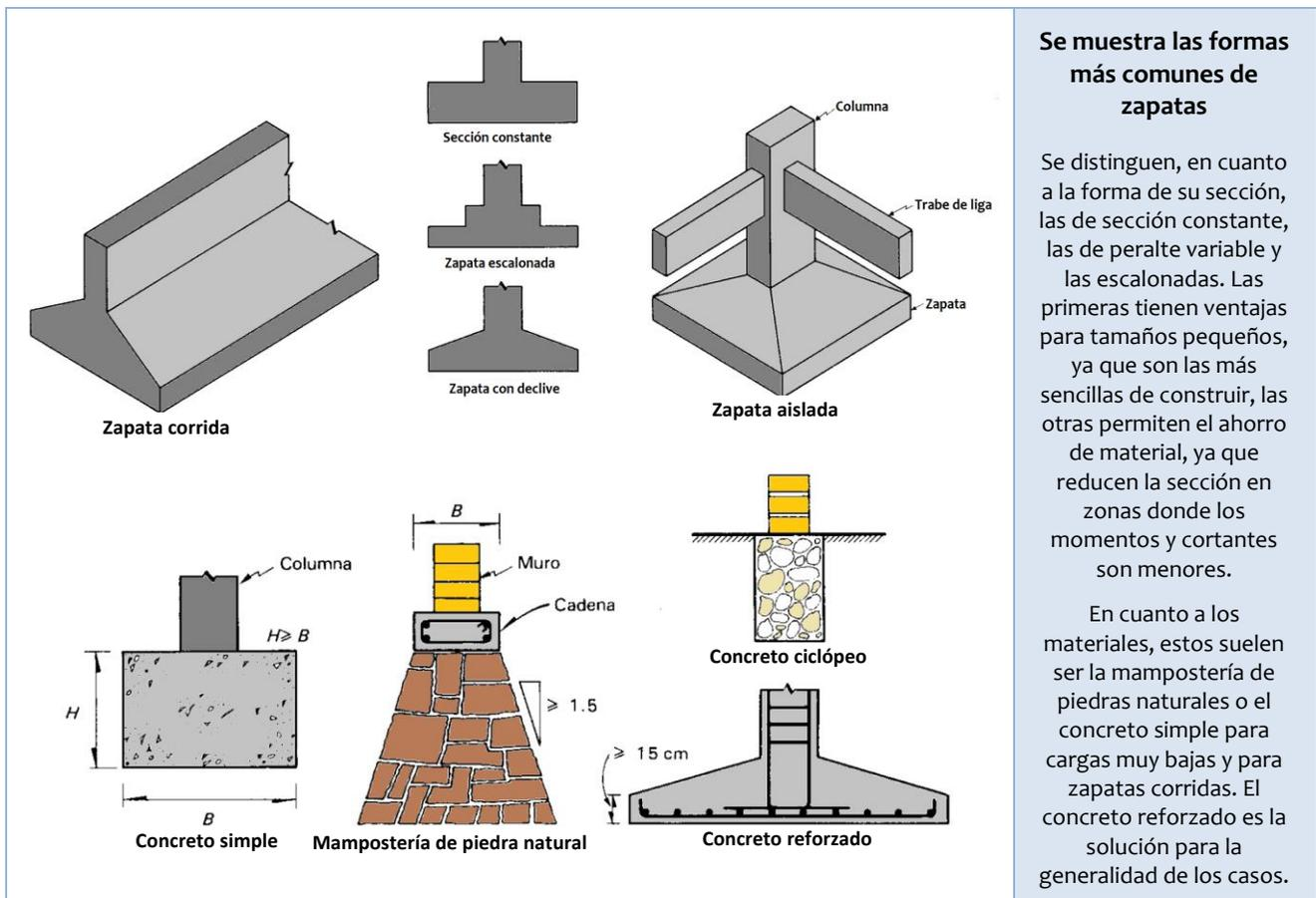
En zonas de riesgo sísmico moderado o grande es conveniente unir las zapatas de una construcción por medio de traveses de liga, cuya función es lograr que la estructura se mueva como una sola unidad ante la acción de un desplazamiento horizontal del terreno, no se pretende que estas vigas absorban los momentos flexionantes, sino solamente fuerzas axiales.
