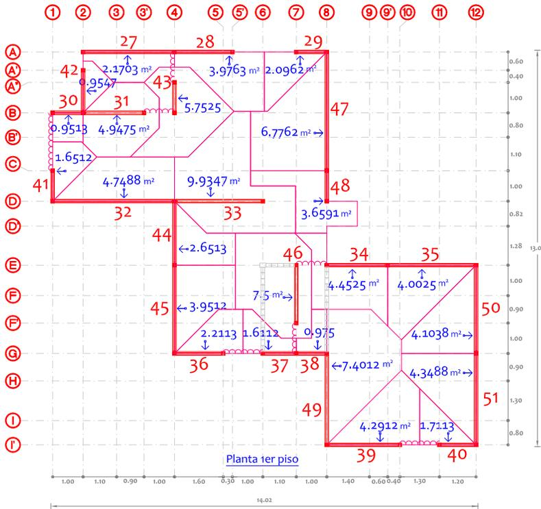
Hay cerramientos de ventanas y puertas que tienen muros altos. Este peso se reparte de acuerdo al área tributaria del muro de carga correspondiente. Para muros con techos inclinados su altura será una elevación promedio.
