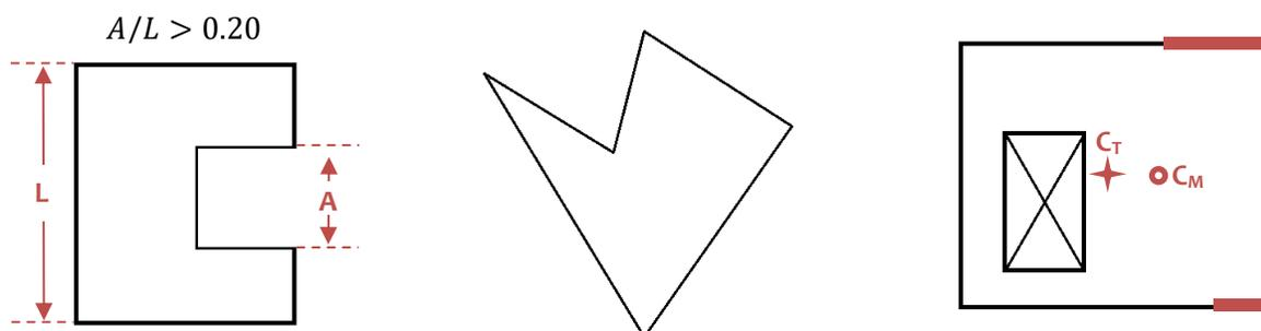
*Formas asimétricas en planta indeseables por tender a producir vibración torsional*
