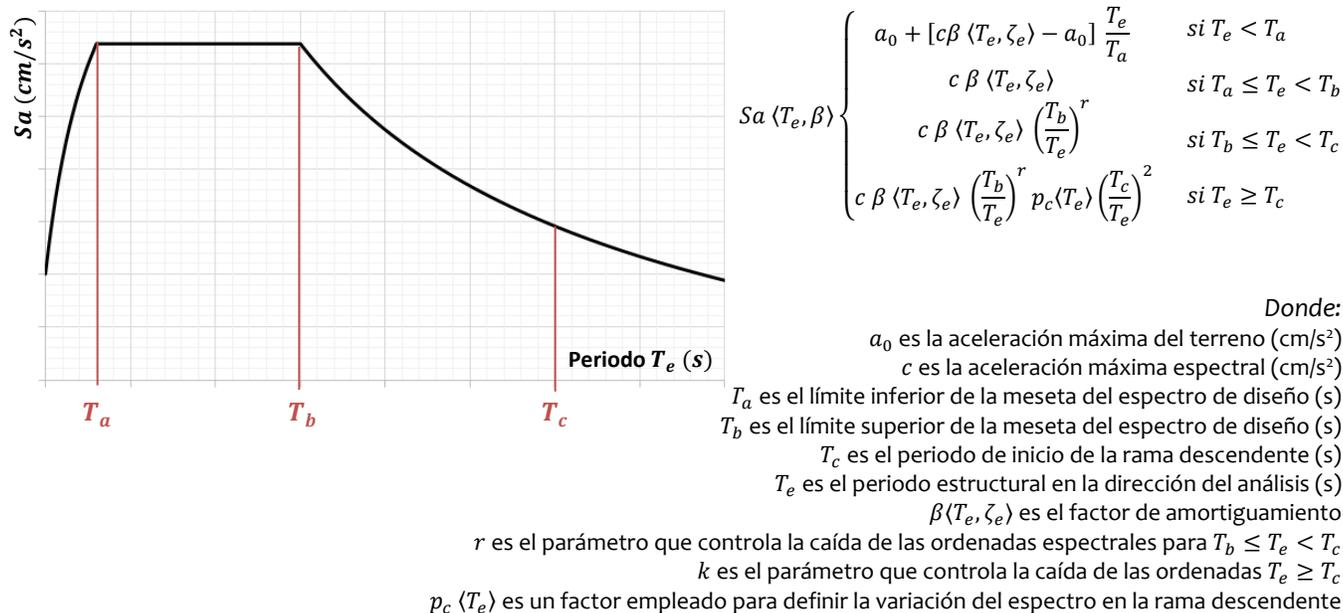
Como índice de la acción de diseño se emplea el coeficiente sísmico,  $c$ , que sirve de base para la construcción del espectro de diseño o puede usarse directamente como la fracción del peso total de la construcción,  $W$ , que constituye la fuerza constante horizontal,  $V$ , que actúa en la base de la construcción.
