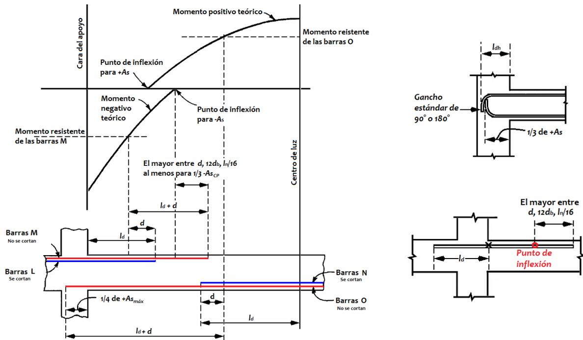
Cuando se cortan las barras en zonas a tensión, existe una tendencia a la formación de grietas prematuras de flexión y de tensión diagonal en la vecindad del extremo cortado. Esto puede generar una reducción de la capacidad a cortante y una pérdida de la ductilidad global de la viga. Como alternativa al corte del acero, las barras de tensión pueden anclarse doblándolas a través del alma y haciéndolas continuas en la cara opuesta.
