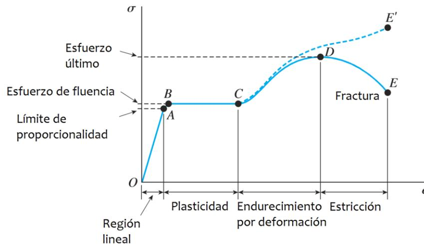
Diagrama esfuerzo-deformación unitaria para un acero común en tensión
