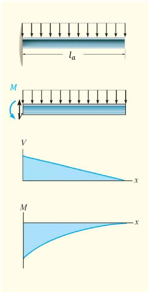
Las losas en una dirección se comportan esencialmente como vigas. Puede considerarse que la losa es una viga cuyo ancho es la longitud del apoyo, o bien, como se hace más frecuente, puede suponerse que la losa está formada por una serie de vigas paralelas e independientes de un metro de ancho que se flexionan uniformemente.
