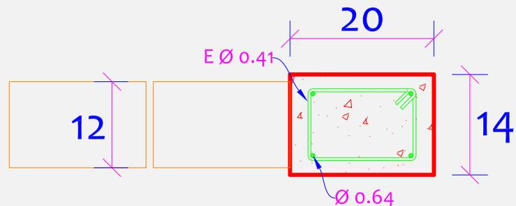
Se propone una sección de concreto de  $14 \times 20 \text{ cm}$ , a continuación, se muestra la sección propuesta:
