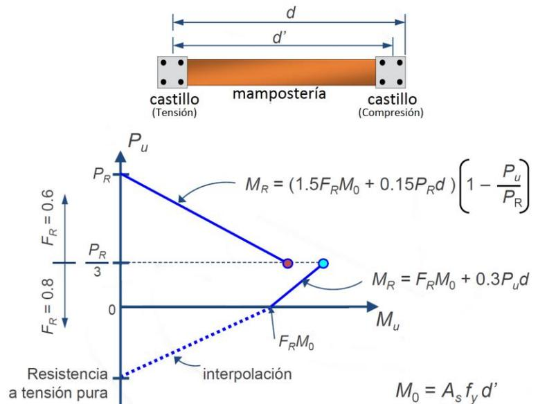
El momento flexionante resistente de diseño de la sección,  $M_R$ , se calculará de acuerdo con las siguientes ecuaciones:
