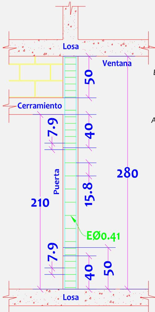
Confinamiento con estribos en castillo de estructura de mampostería Tipo II
