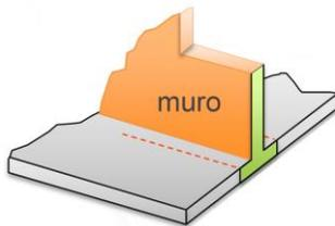
Para el caso de muros que contengan aberturas, éstos podrán modelarse como columnas anchas equivalentes, solamente si el patrón de las aberturas es regular en elevación. En el primer nivel debe modelarse con una columna ancha y elementos rígidos, pero esto últimos deben estar articulados en sus extremos. En los niveles superiores, la sección del muro bajo debe incluirse en la sección de la trabe. Dicha trabe es continua.
