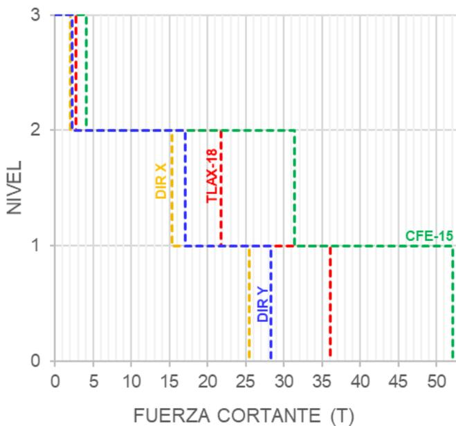
Cortante sísmico de colapso en dirección Y
