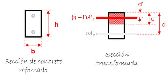
El momento de inercia de la sección agrietada para vigas doblemente armadas se puede calcular a partir de la siguiente expresión:
