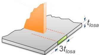
1. Cuando el acoplamiento de muros es a nivel de la losa, ésta debe modelarse poniendo un elemento cuya sección tiene el espesor de la losa, ésta debe modelarse poniendo un elemento cuya sección tiene el espesor de la losa y su ancho es tres veces dicho espesor.
