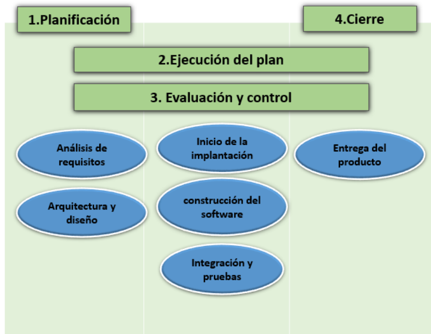
Figura 2.3 Las actividades de los procesos del Perfil Básico ISO/IEC 29110-5-2-1. (de creación propia)
