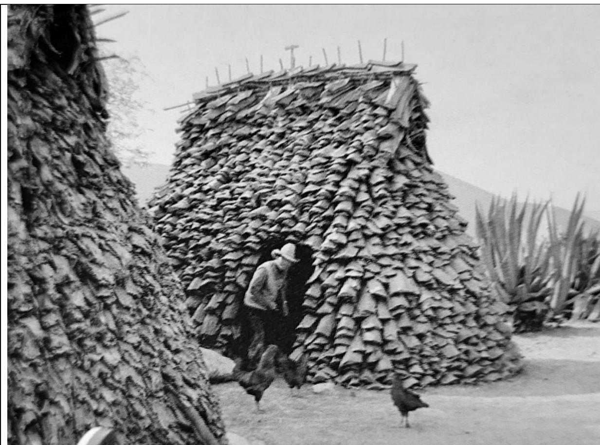
Figura 04 (Cap. 2): Ejemplo de casa construida con penca de maguey en su totalidad
