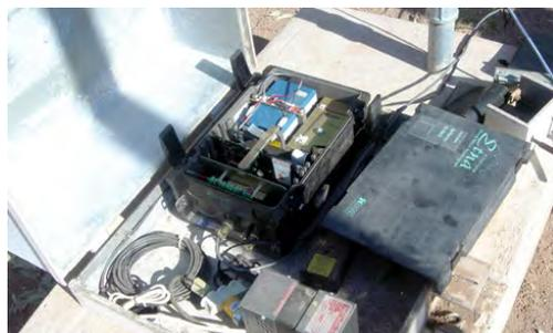
Colocación de acelerógrafo digital, en institución.
