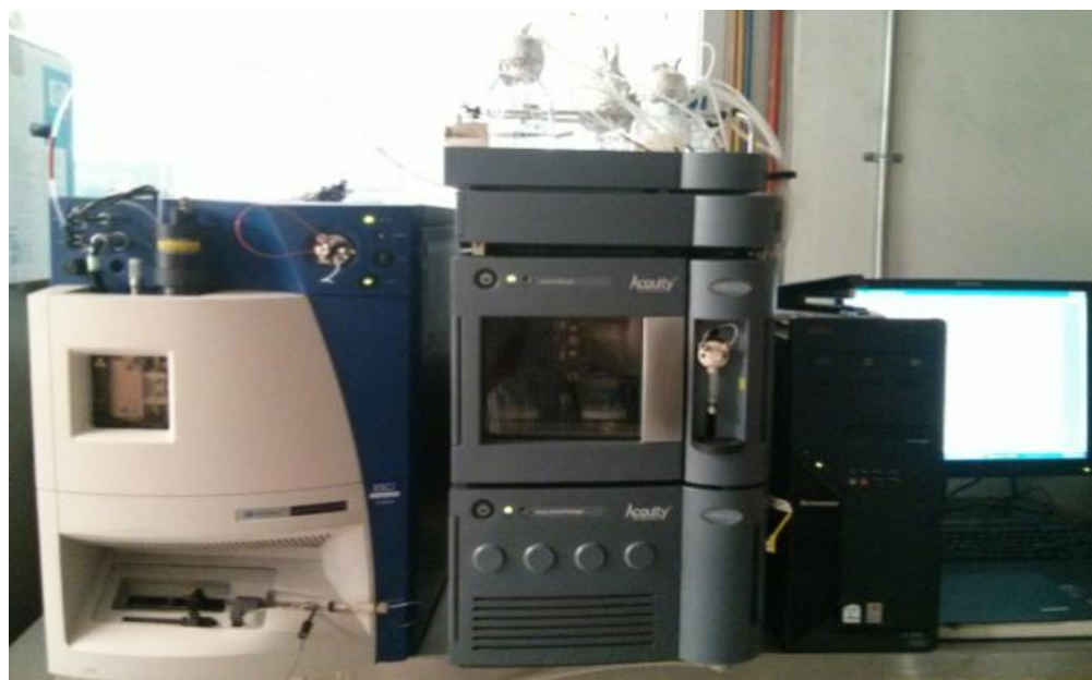
Figura 10. UPLC-MS/MS utilizado en el laboratorio de Farmacología, INP.
