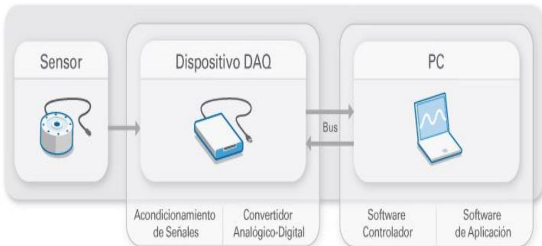
Figura 2-1 Sistema de adquisición de datos
