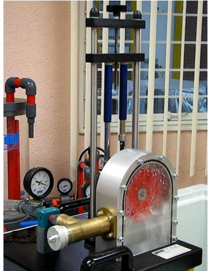
Ilustración 57 foto de banco de pruebas de turbina Pelton
