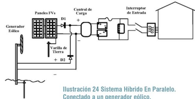
**Ilustración 24 Sistema Híbrido En Paralelo. Conectado a un generador eólico.**
