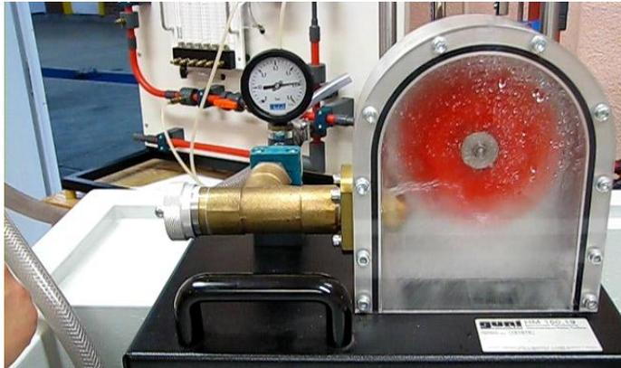
Ilustración 59 accionamiento de banco de pruebas de turbina Pelton.
