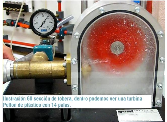
Ilustración 60 sección de tobera, dentro podemos ver una turbina Pelton de plástico con 14 palas.
