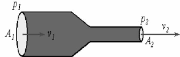
Ilustración 62 Tubo de Venturi
