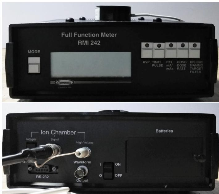
**Figura 2.1:** Vista frontal y delantera del equipo detector multipropósito marca Gammex, modelo RMI 242
