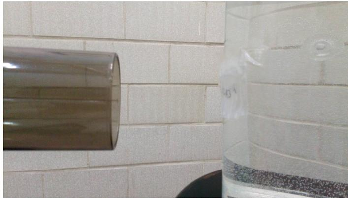
**Figura 2.5:** Montaje experimental para la medición del kerma en aire a la entrada del paciente.
