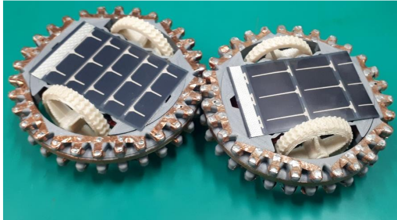
Figura 33: Modelos de ingeniería de robots con subsistemas implementados.
