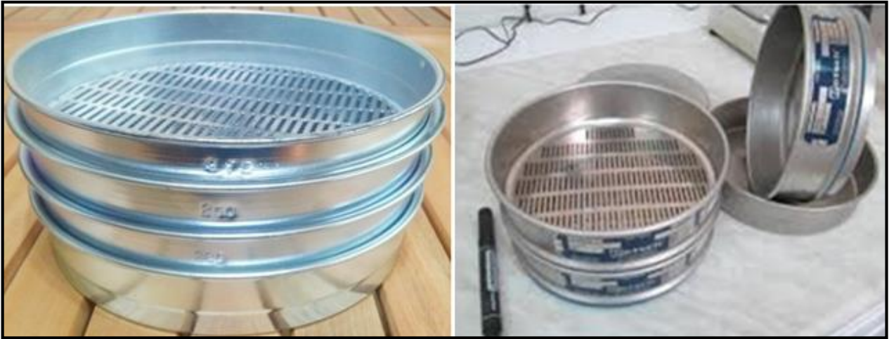
Figura 21. Cribas para clasificar el grano
