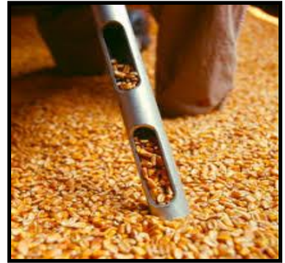
Figura 12. Muestreo con calador
