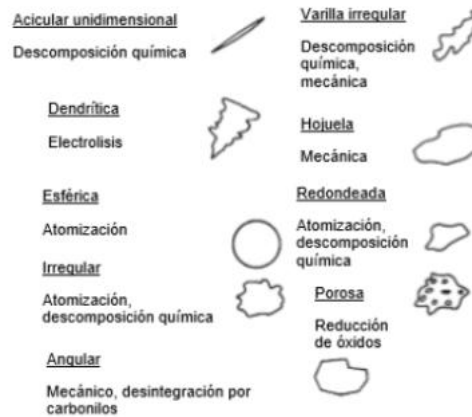
Figura 2.1 Morfología de partícula y proceso de producción. [2]
