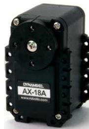
Figura 3.36 Servomotor Dynamixel AX-18A utilizado para mover el efector final del manipulador. [69]
