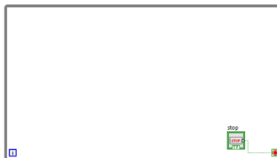
Figura 3.25. Estructura while y botón de paro general
