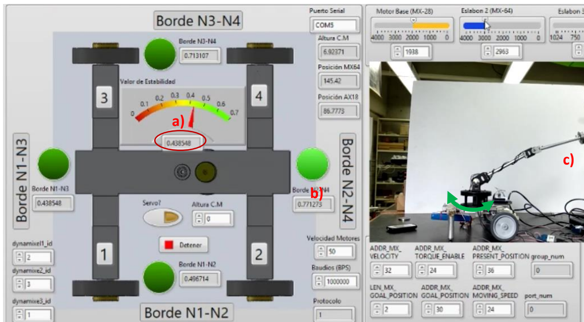
Figura 3.48. Prueba del caso 2 (continuación). a) Valor de estabilidad de 0.438548N/m. b) Indicador LED mostrando la ubicación del manipulador (borde N2-N4) c) Ubicación del efector final con respecto al LED del borde N2-N4, se puede apreciar que este se encuentra más alejado del borde y de la base.
