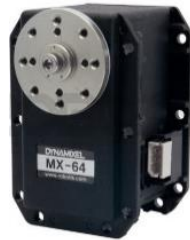
Figura 3.35. Servomotor Dynamixel MX-64T utilizado para mover el brazo manipulador desde la base.
