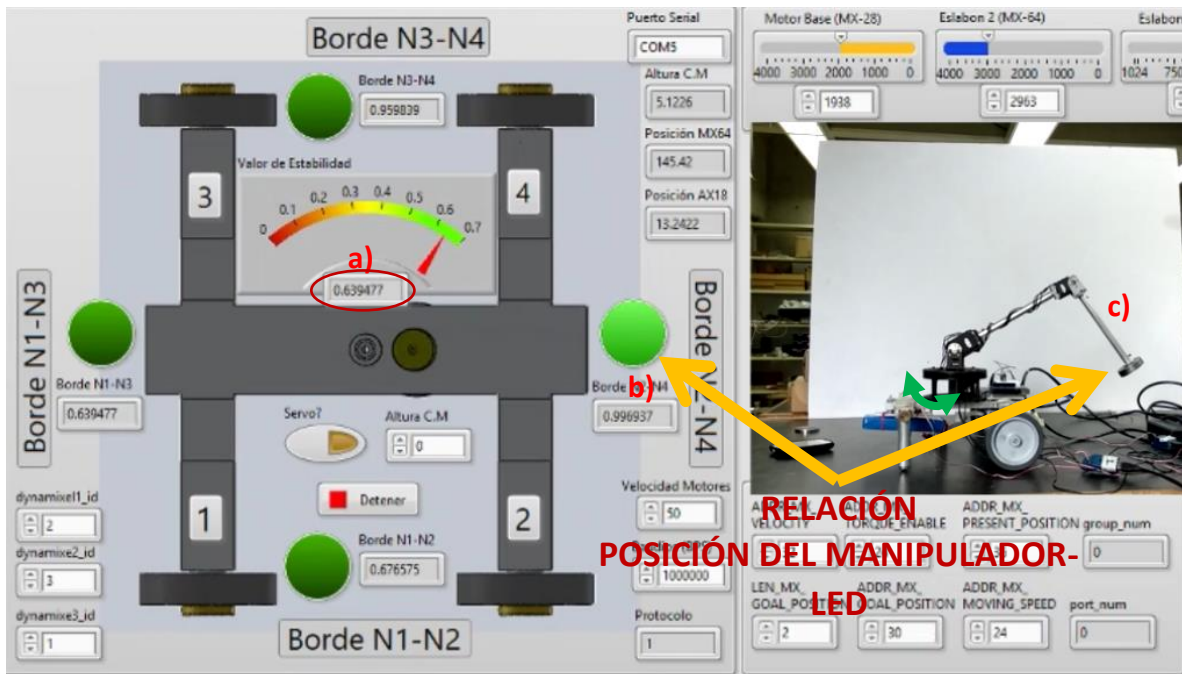
Figura 3.47. Prueba del caso 2. a) Valor de estabilidad de 0.639477N/m. b) Indicador LED mostrando la ubicación del manipulador (borde N2-N4) c) Ubicación del efector final con respecto al LED.
