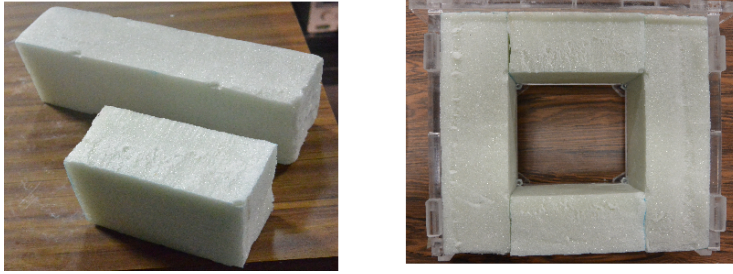
Figura 2.20: Tipos aislantes manufacturados y su lugar en el dispositivo
