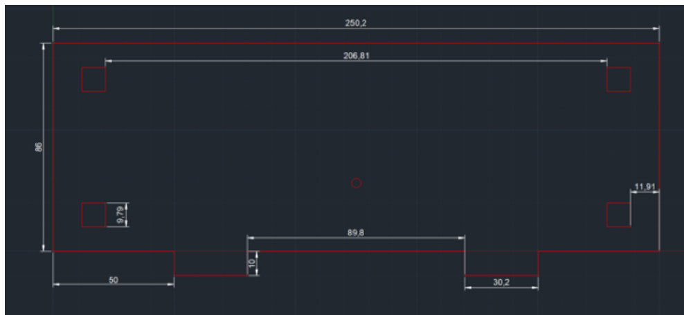
Figura 2.13: Plano frontal del dispositivo realizado con AutoCAD
