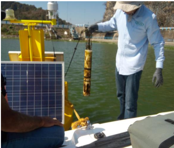
Figura A.2.5. Sonda multiparamétrica recién sacada de la Presa
