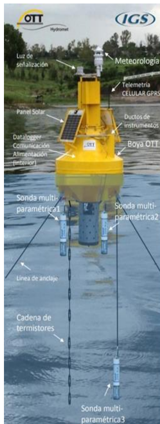
Figura 3.2. Boya con Sondeas de Calidad del Agua y Cadena de Termistores (IGS, 2019)
