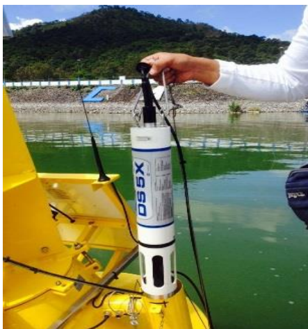
Figura 3.5. Sonda en Boya (CONAGUA, 2013)
