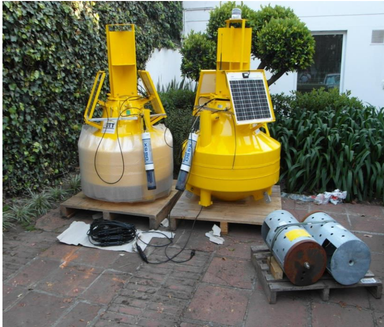
Figura 3.1. Boya de calidad del agua (Fotografía cortesía del Biólogo Martín Castro Juárez)
