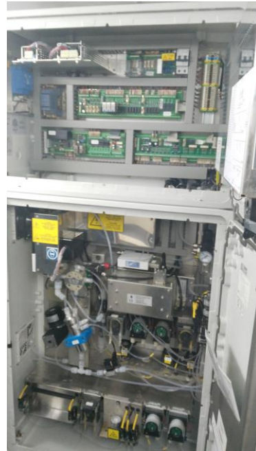
Figura 3.13. Interior del BioTector 7000 (CONAGUA, 2013)
