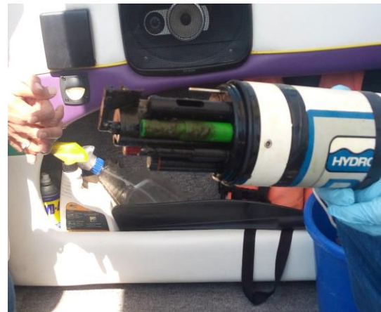
Figura A.2.10. Sensores ubicados en la sonda
