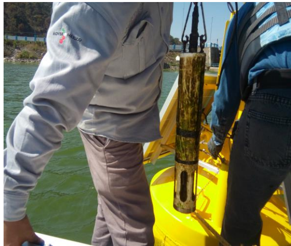
Figura A.2.6. Sonda multiparamétrica cubierta de algas
