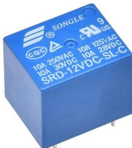
Figura 38. Relevador de 12V D.C. Modelo SRD-12VCD-SL-C (Songle, 2019)
