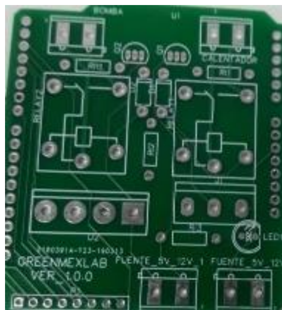
Figura 60. Circuito PCB de la etapa de control de la temperatura y la electróbomba
