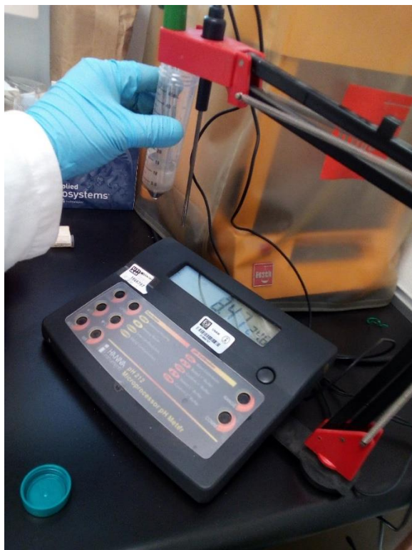
Figura 25. Medición del pH del sedimento con el “Microprocessor pH Meter”.
