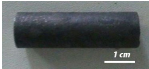
Figura 19. Cilindro de aproximadamente 4cm de longitud del acero W1.
