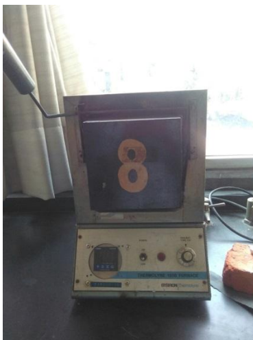
Figura 18. Mufla empleada en los tratamientos térmicos realizados en el presente trabajo.
