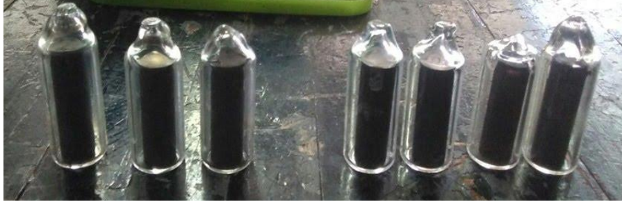
Figura 21. Ejemplo del encapsulado de los cilindros sometidos a tratamiento de esferoidización.
