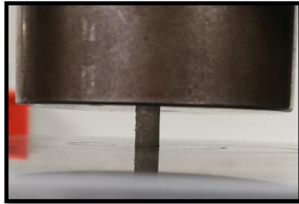
Figura 31. Prueba de resistencia a compresión.
