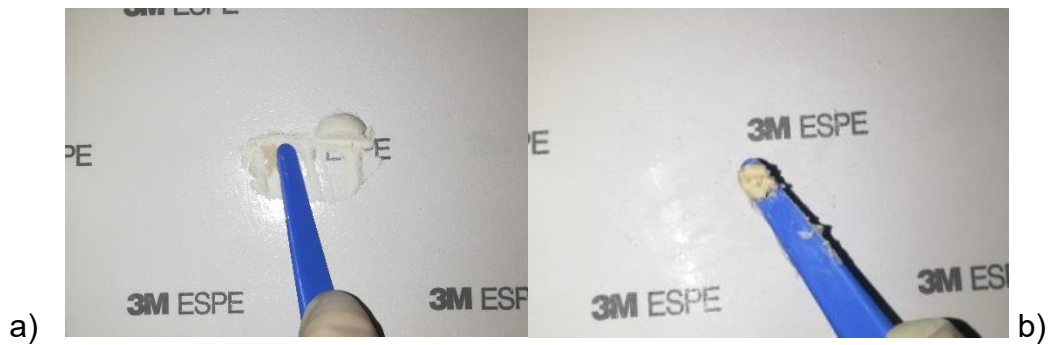
Figura 8. Mezcla del material. a) Transferencia del polvo al líquido. b) Mezcla homogénea.
