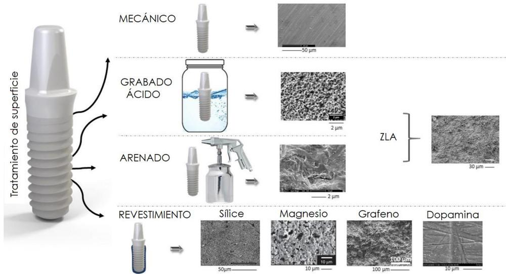
Figura 24 Métodos de tratamiento de superficie de los implantes de zirconia.
